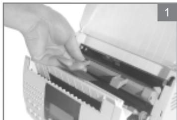
1- Ouvrez l'ensemble analyse en appuyant sur les deux boutons situés sur les côtés comme indiqué dans le chapitre INCIDENTS DE FONCTIONNEMENT paragraphe : **incidents imprimante**.
