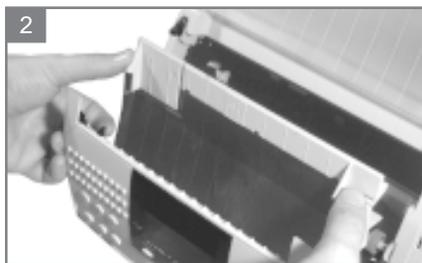
1-2- Ouverture de la platine mobile : poussez les deux clips verts (c) vers l'arrière de l'appareil pour dégager la platine mobile
