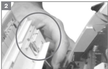
2. Ouvrez l'ensemble analyse en appuyant sur les deux boutons situés sur les côtés.
