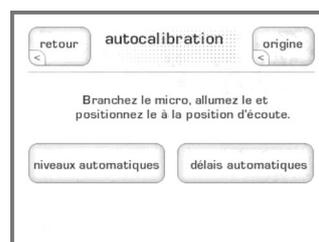
Branchez simplement le microphone dans l'entrée repérée **mic** sur la face arrière de l'appareil, puis positionnez le microphone à la position voulue, et enfin pressez successivement les touches **auto levels** et **auto delays**, afin que le SSP-600 lance automatiquement ses procédures de calibration par génération de signaux test, et règle pour vous de manière optimale le système.
