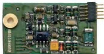
l'aiguillage numérique peut être immédiatement en place à n'importe quel endroit de la trame. À l'aide de CV's personnels, il est possible de modifier certaines propriétés du décodeur. Par mesure de sécurité, le décodeur est protégé contre la surchauffe et les court-circuits. Remarque à l'attention des utilisateurs de la Lokmaus® 1 & 2 : Ce décodeur d'aiguillage ne comprend que les adresses d'aiguillages «réelles». Il ne réagit plus aux adresses de locomotives.
