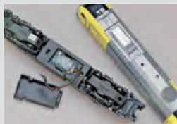
3. Mettez le décodeur sur place comme décrit. Renseignement : un connecteur femelle de l'interface sur la platine de la locomotive est marqué avec une étoile. Le câble orange du connecteur mâle du décodeur doit y être ajusté.
