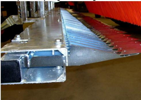
Sur l'illustration ci-dessous, qui montre la poutre de l'outil vue de derrière dans le sens de la marche, est visible l'échelle graduée en millimètres qui indique l'angle des porte-lames.
