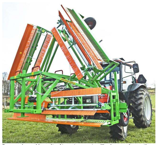
Pour que la machine soit prête au transport, veiller à ce que les sections rabattables reposent correctement dans les supports prévus à cet effet et situés au-dessus de la partie centrale.
