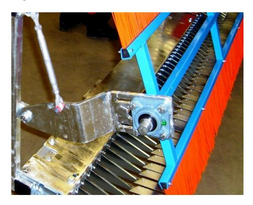
Il y a en tout 14 raccords (CombiCut 6005) 18 (CombiCut 8003) de graissage sur la machine. On trouve un raccord dans chaque logement de palier de l'arbre des brosses rotatives, voir illustration ci-dessous. Ces raccords sont lubrifiés de quelques coups de graisse au moyen d'un pulvérisateur à main. À chaque extrémité des vérins de levage se trouve également un raccord de graissage, de même qu'à chaque charnière de levage des sections extérieures, voir l'illustration.
