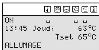
6. Après l'allumage, la flamme est détectée et l'appareil est mis en service. Cela signifie que le chauffage a effectivement débuté :
