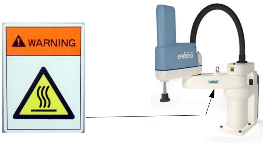
Figure 2.2 : avertissement de danger thermique sous le segment intérieur
