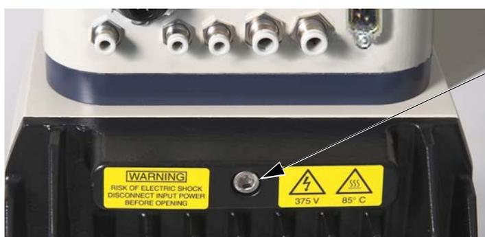
Vis de fixation de l'AIB
