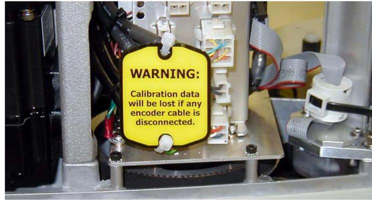
Figure 2.3 : avertissement sur les câbles du codeur
