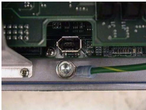
**Figure 7.5 : vis du fil de terre du châssis de l'AIB**
