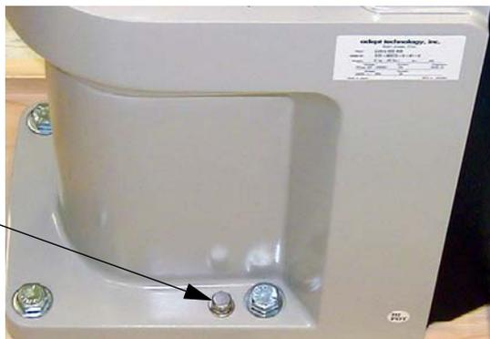
Figure 4.11 : mise à la terre à partir de la base du robot
