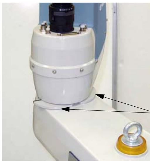
Plaques de la butée ajustable d'articulation 2 montées à l'Emplacement 1.
