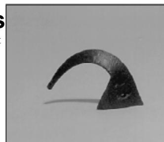
Un cône autoportant cuit à maturité. Ne pas se soucier si la pointe est légèrement plus haute ou plus basse que sur la photo.
