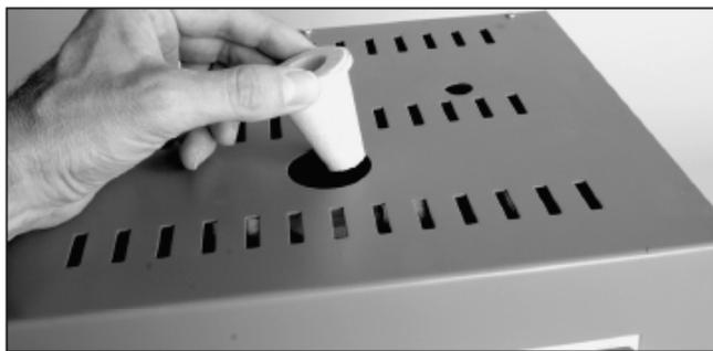
Pour une cuisson avec la pâte de liège (cork clay) retirer le bouchon au début et jusqu'à environ 430°C. Maintenir la température pendant une heure. Après ce palier remettre le bouchon. Maintenir la porte fermée pendant la phase de ventilation.
