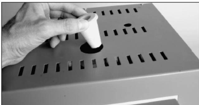
Certains types de cuisson, comme celle de la céramique ou de la fonte à la cire perdue produisent des vapeurs qui doivent être ventilés du four. Les pâtes d'argent et d'or demandent aucune ventilation sauf si elles contiennent un matériau combustible comme dans le cas d'une forme creuse ou si elles sont associées à d'autres matériaux comme le verre.
