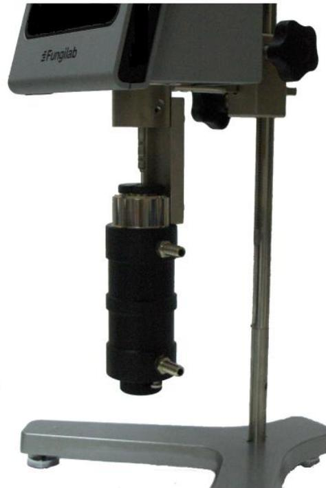
Fig.8: Adaptateur LCP monté sur le viscosimètre
