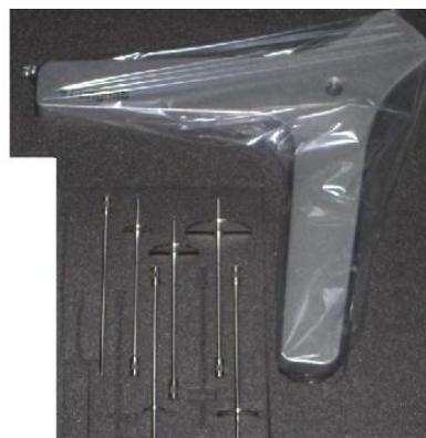
Fig. 1. Viscosimètre dans sa mallette de transport
