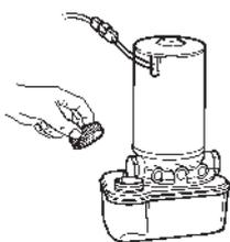
Vérifiez que le niveau d'huile se situe entre MAX et MIN dans le réservoir lorsque la transmission est positionnée. Pour l'indice d'huile, consultez les «Caractéristiques techniques».
