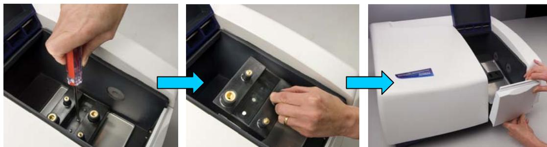
Faire glisser délicatement le support de cuve thermostaté à circulation d'eau dans le Modèle 6800 et vérifier que les trous d'ajustage de l'accessoire sont alignés avec les ergots d'ajustage de l'appareil. Fixer l'accessoire en serrant doucement la vis sur l'appareil à l'aide du tournevis fourni.
