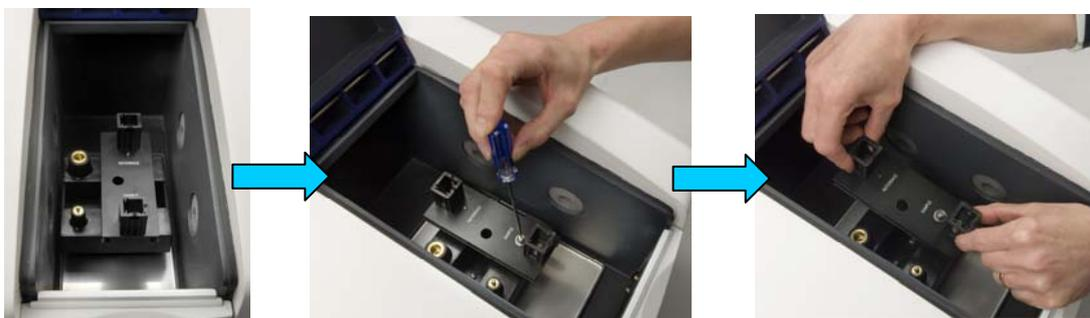
Après avoir retiré le support de cuve standard 10 x 10 mm, à l'aide du tournevis livré, dévisser le bloc d'ergot de la plaque de base. Abaisser délicatement le support de Micro Cuve dans le compartiment échantillon et fixer l'accessoire en serrant doucement la vis sur la plaque de base avec le tournevis livré.
