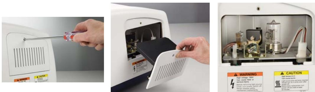
Un remplacement de la source lumineuse peut s'avérer nécessaire pendant la durée de vie de l'appareil. Toute défaillance de la lampe sera détectée par le test automatique du système au moment de la mise sous tension de l'appareil.
