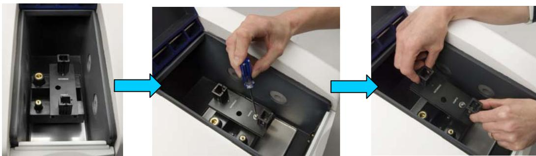
Après avoir retiré le support de cuve standard 10 x 10 mm, à l'aide du tournevis livré, dévisser le bloc d'ergot de la plaque de base. Retirer délicatement la plaque de base de l'appareil en soulevant le panneau avant et en le tirant doucement vers l'avant (voir ci-dessous).
