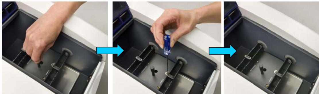
**Remarque :** ne pas trop serrer la vis de fixation car cela pourrait endommager le spectrophotomètre et l'accessoire.
