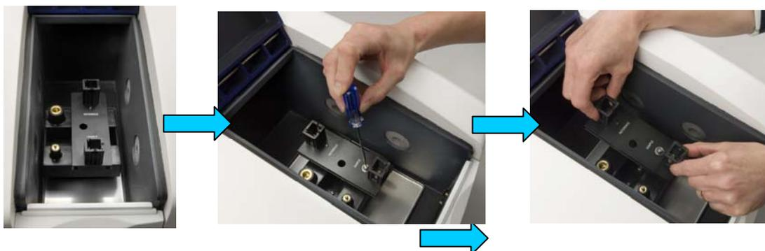
Abaisser délicatement le support de filtre de verre dans le compartiment échantillon, en s'assurant que les ergots d'ajustage se positionnent dans les trous d'ajustage de l'accessoire. Une fois en place, fixer l'accessoire en serrant doucement la vis de fixation à l'aide du tournevis livré.
