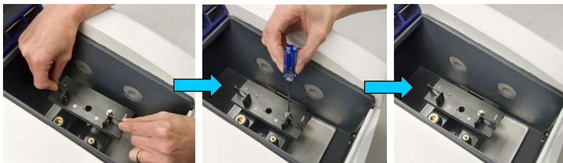
**Remarque :** ne pas trop serrer la vis de fixation car cela pourrait endommager le spectrophotomètre et l'accessoire.
