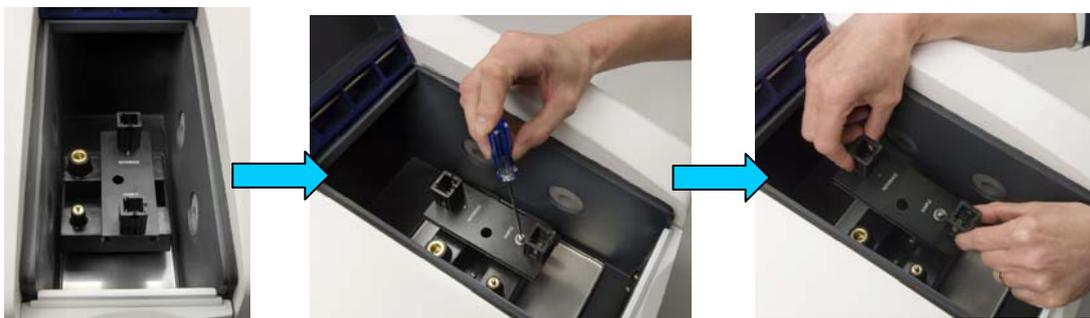
Abaisser délicatement le support de film dans le compartiment échantillon, en s'assurant que les ergots d'ajustage se positionnent dans les trous d'ajustage de l'accessoire. Une fois en place, fixer l'accessoire en serrant doucement la vis de fixation à l'aide du tournevis livré.
