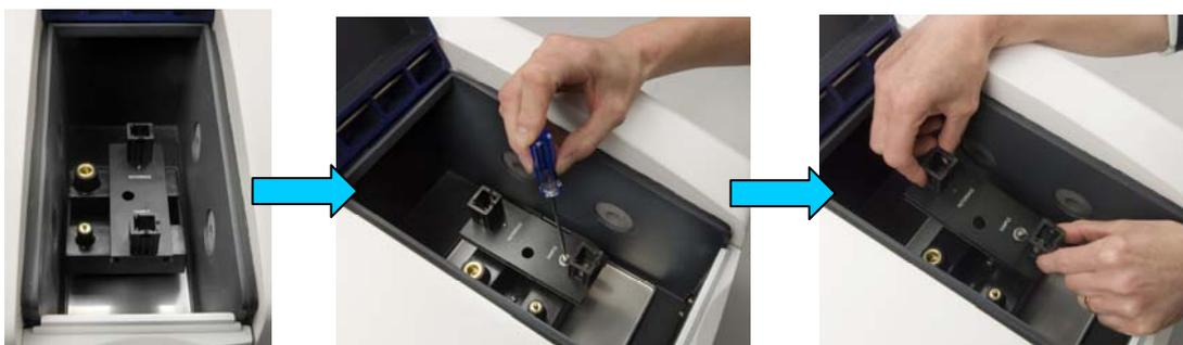
Abaisser délicatement le support de cuve rectangulaire à long trajet optique dans le compartiment échantillon, en s'assurant que les ergots d'ajustage se positionnent dans les trous d'ajustage de l'accessoire. Une fois en place, fixer l'accessoire en serrant doucement la vis de fixation à l'aide du tournevis livré.
