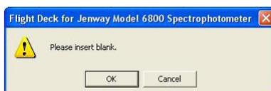
Placer les cuves contenant le blanc/solvant de réaction dans le support de cuve de référence (arrière) et dans le support de cuve échantillon (avant) et cliquer sur **OK**.
