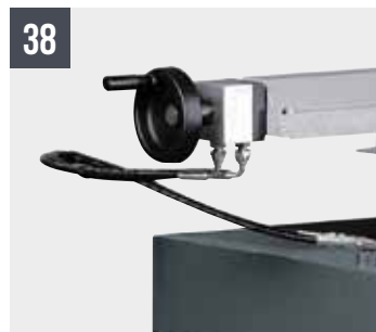
Shark 332/382/452-1 CCS HYDRA Étau hydraulique
