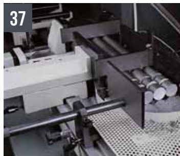
Guide réglable pour la chute des pièces coupées
