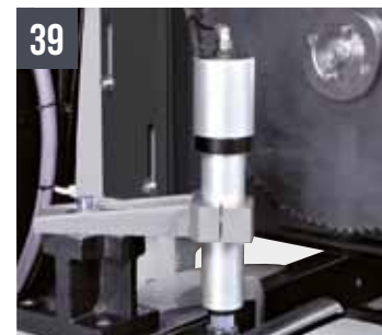
TIGER 352MA/COBRA 352MA Étau vertical pneumatique
