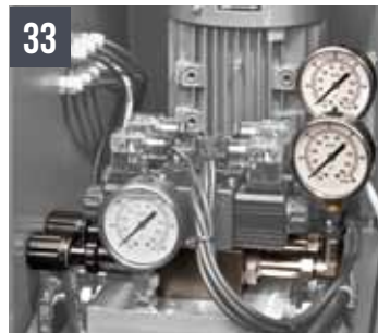
SHARK NC 5.0 Régulateur pression étaux hydrauliques
