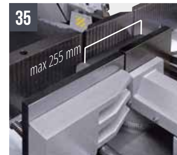
SHARK 332 NC 5.0 Étau spécial pour réduire la chute
