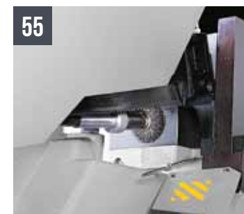
55 SHARK 332 SXI/NC 5.0 - Dispositif de nettoyage de la lame par brosse avec moteur
