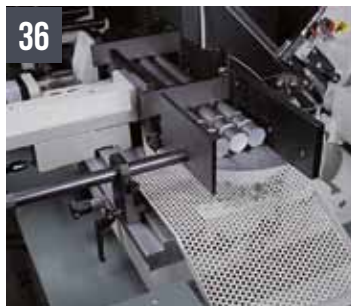
Dispositif pour la coupe en paquet et guide réglable pour le déchargement (max 240x90)
