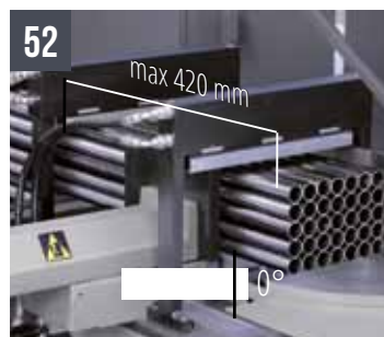
52 SHARK 332 NC 5.0 - Étaux verticaux hydrauliques pour coupe en paquets (max 320x160 mm)
