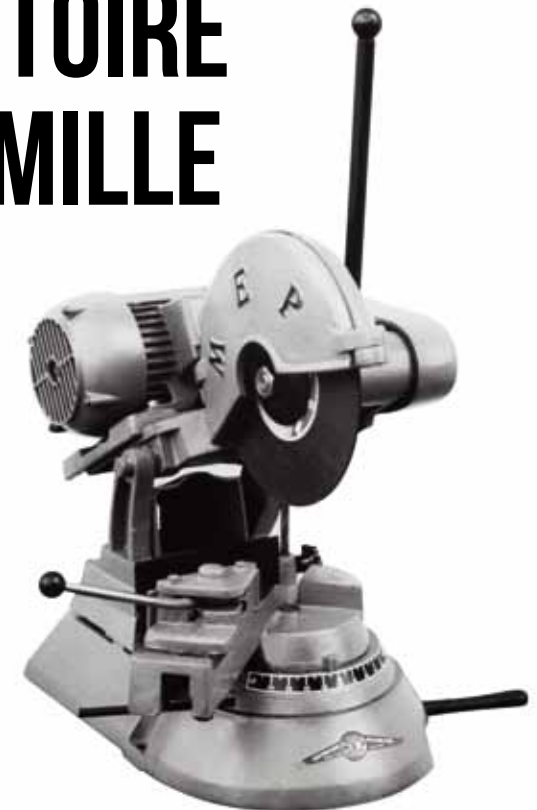
MEP TV 300 Le premier modèle de machine à tronçonner à disque abrasif construite en série
