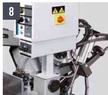
SHARK 282 - KIT CCS Cut Control System (système pour coupe sans opérateur)
