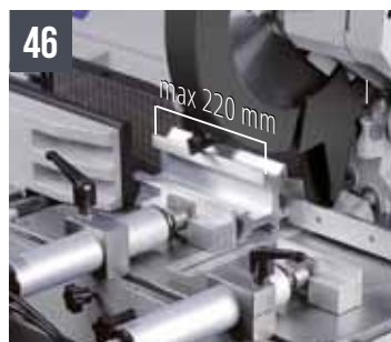
46 COBRA 352 NCe 5.0 Étau spécial pour réduire la chute
