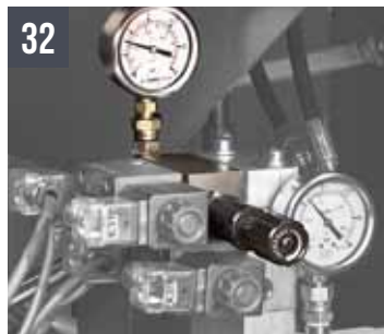
SHARK SXI evo Régulateur pression étau hydraulique
