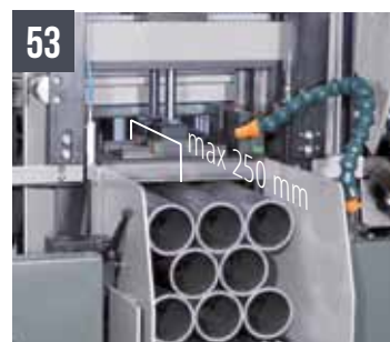
53 SHARK 230 NC HS 5.0 - Étaux verticaux hydrauliques pour coupe en paquets (max 230x230 mm)
