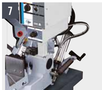
SHARK 281 - KIT CCS Cut Control System (système pour coupe sans opérateur)
