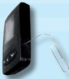
Introduisez une fine tige (trombone, etc.) dans le trou situé sur le côté de l'appareil, puis retirez-la. L'appareil redémarre.
