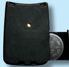
Faites glisser le couvercle du logement des piles et retirez-les. Installez les nouvelles piles en veillant à bien respecter la polarité. Utilisez uniquement des piles CR-2325 ou un modèle équivalent.
