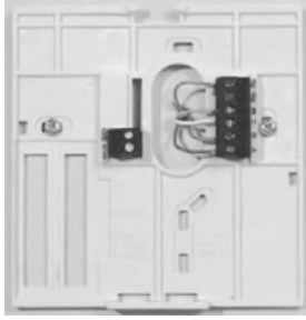
Fig. 2 - Fixez les câbles sur la plaquette de connexions
