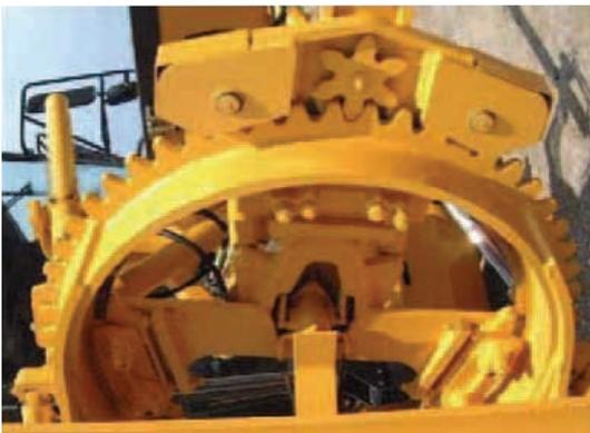
Elle peut même être tellement **déplacée sur le côté** qu'elle se trouve à la **verticale** à côté de l'engin. Pour ce faire, une **potence pivotante** est installée sur le châssis. La potence est **déverrouillée** pour pivoter. Elle est à nouveau **verrouillée** pendant le travail.
