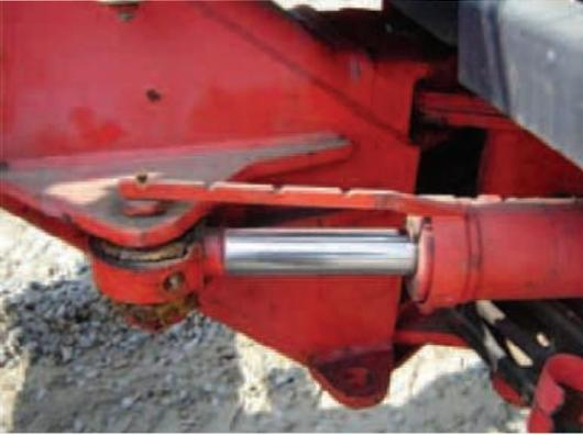
Des **points de repère** sont parfois marqués sur les parties actives afin d'aider le conducteur à savoir où en est le réglage de l'engin. Le conducteur a ainsi une vue générale des **réglages de base**. Un exemple en est le marquage destiné à **aligner** le **châssis** de travail sur le **train de roulement**.
