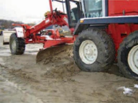
On peut ainsi adapter la vitesse selon le type de travail, la quantité de matériau à déplacer et la situation du terrain. Dans certains cas, on travaille aussi en **marche arrière** avec une niveleuse. Pour cela, il faut faire **pivoter la lame à 180°**.
