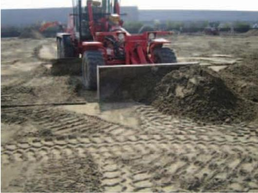
L'équipement frontal est commandé par l'hydraulique depuis la cabine. L'équipement frontal consiste dans la plupart des cas en une espèce de **lame bull**, qui étale déjà une grande quantité de matériau avant que la lame niveleuse entre en contact avec ce dernier. On peut même monter un **scarificateur** sur le **dispositif de relevage frontal**.
