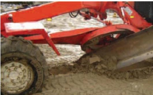
La lame peut coulisser à l'**horizontale**. Il est également possible de régler l'**angle formé avec le plan horizontal**. La lame peut aussi **pivoter**. Pour cela, elle est montée sur une **couronne** (cercle denté).
