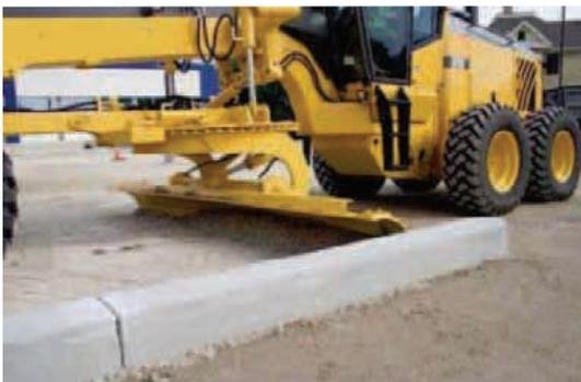
La partie centrale du châssis comprend la lame niveleuse. C'est pour cette raison que le châssis a une forme spéciale, destinée à donner à la lame **l'espace de manœuvre** nécessaire.
