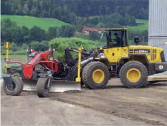
Les niveleuses fonctionnent suivant le même principe que les boteurs. Si les quantités déplacées sont plus petites, le **degré de finition**, par contre, est beaucoup plus élevé. C'est pour cette raison que les niveleuses sont principalement utilisées pour la **finition de surfaces**: nivellement de coffres en **travaux routiers** et ferroviaires, nivellement de parkings, de hangars et de diverses **grandes surfaces** qui nécessitent **beaucoup de précision**.
