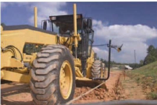
Traceur, appareil laser avec récepteur, GPS, ...
