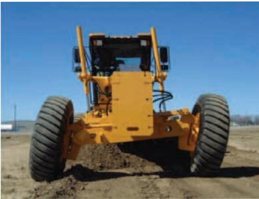
En présence de **talus raides** de moins de 4/4, l'engin roule **au pied** du talus. La lame est positionnée dans **l'inclinaison correcte** et sa position est corrigée **en permanence** pendant que l'engin roule.
