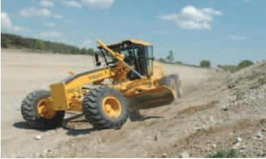
Avec des talus plats de 10/4 et plus, l'engin peut même rouler sur le **talus**. Les roues avant sont placées le plus verticalement possible. Ainsi, l'engin n'a pas tendance à glisser du talus.
