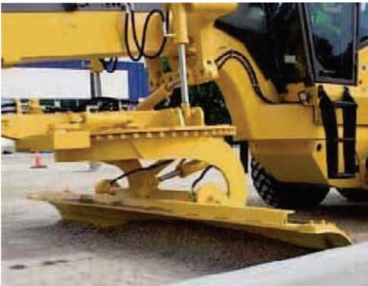
Les premières niveleuses étaient tractées. A l'heure actuelle, un **grader** est une espèce de tracteur sous lequel est montée une lame niveleuse. Cette lame à commande hydraulique peut pivoter à la **verticale** et à l'**horizontale**.
