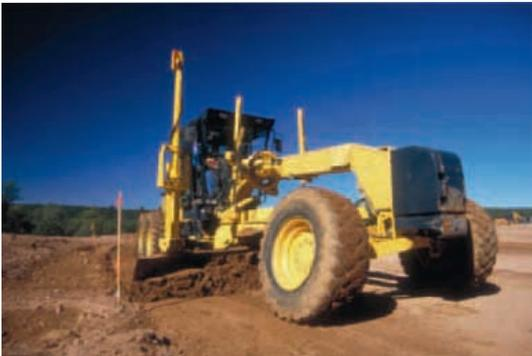
Les niveleuses s'utilisent habituellement pour nivelier. Pour ce faire, le conducteur de l'engin doit régler **en permanence la hauteur** de la lame. Cela réclame beaucoup d'adresse. Il existe actuellement des appareils qui aident le conducteur d'engins à **contrôler la hauteur** et même à la **corriger**.
