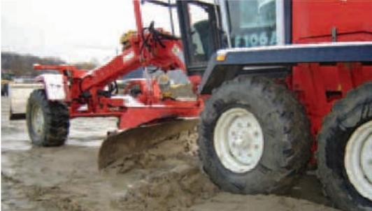
Certains types de niveleuses sont équipés pour fonctionner aussi **en marche arrière**. Dans ce cas, la partie lame pivote à **180°**.
