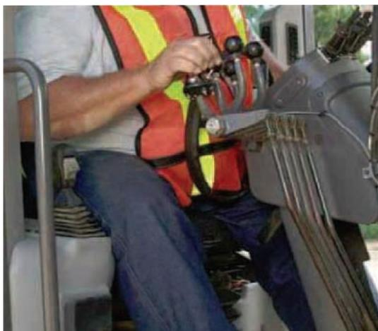
Le scarificateur est monté sur un dispositif de relevage **hydraulique à double effet**; il sert à ameublir les couches dures. Sa commande s'effectue évidemment depuis la cabine.
