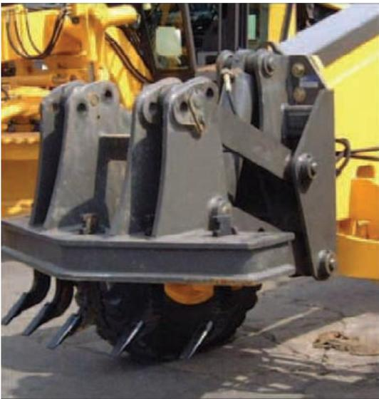
Un **scarificateur frontal** peut aussi être monté comme équipement sur une niveleuse. Le scarificateur frontal sert à **ameublir la couche sous-jacente**.
