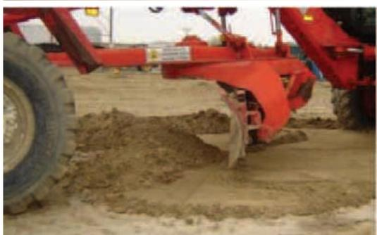
Réglage de l'angle d'attaque de la lame
