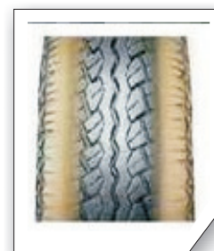
Usure sur les flancs
