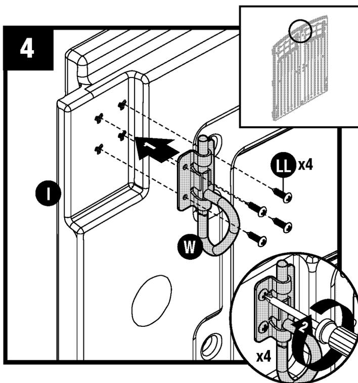
Sur le côté intérieur supérieur de la porte gauche (I), fixez le verrou coulissant avec anneau en D (W) aux trous prévus à cet effet à l'aide de quatre vis (LL).
