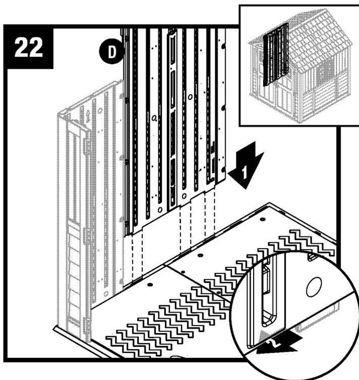
Alignez les languettes du panneau latéral (D) sur les fentes des parties avant et arrière du plancher. Abaissez le panneau dans les fentes et bloquez-le en le faisant glisser vers le coin avant.
