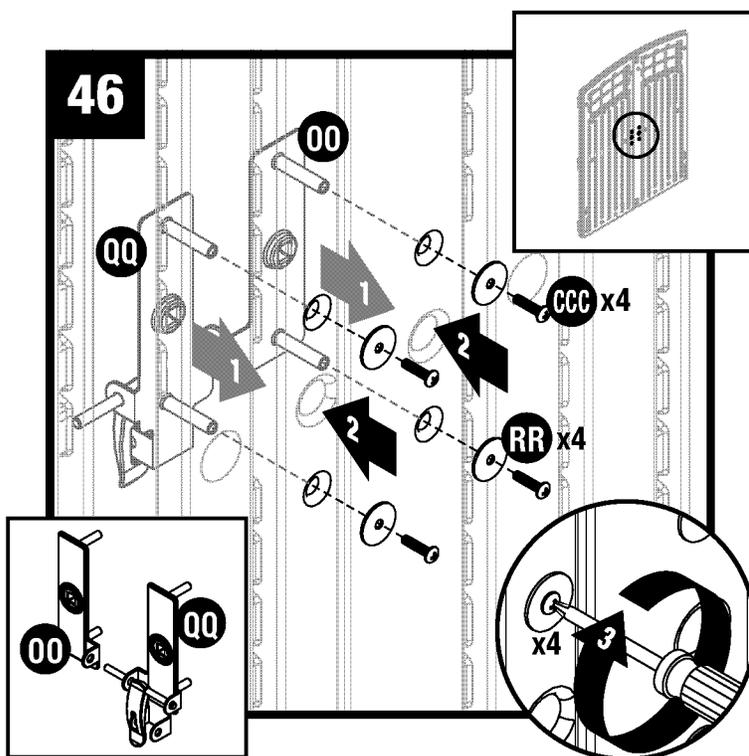
Insérez à travers les orifices prépercés des portes les tiges de vis sur les plaques (OO) et (QQ) de poignée de gauche et de droite. Tout en maintenant bien les plaques à l'extérieur de la porte, fixez chacune d'elles à l'aide de deux rondelles (RR) et de deux vis à métaux (CCC).
