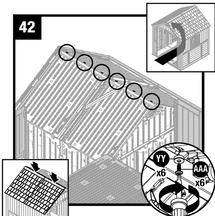
Poussez le toit vers le bas à partir de l'extérieur. Depuis l'intérieur de la remise, fixez les panneaux de toit ensemble le long du bombement du toit avec six rondelles en caoutchouc (YY) et six vis d'étanchéité (AAA).
