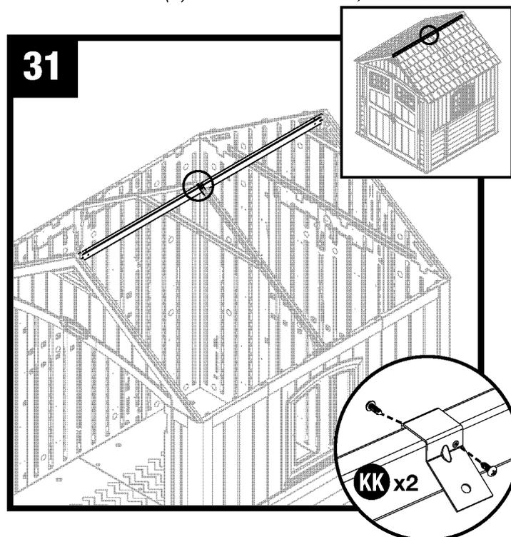
Fixer les fermes de toit à la barre faîtière avec une vis (KK).
