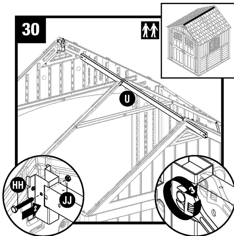
Glissez la poutre faîtière (U) et insérez-la dans le support de la poutre faîtière avant. Fixez à l'aide d'une vis à tête hexagonale de 5,08 cm (2 po) (HH) et d'un écrou (JJ).
