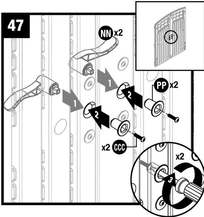
Depuis l'extérieur des portes, insérez les poignées de porte (NN) à travers les orifices de la plaque de poignée. À l'intérieur des portes, placez des entretoises (PP) sur chaque poignée de porte et fixez chacune d'elles à l'aide d'une vis à métaux (CCC).
