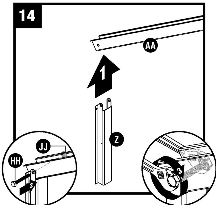
Placez un support d'adaptateur latéral (Z) à l'extrémité du chevron de ferme (AA). Fixez-le à l'aide d'une vis à tête hexagonale de 5,08 cm (2 po) (HH) et d'un écrou (JJ).
