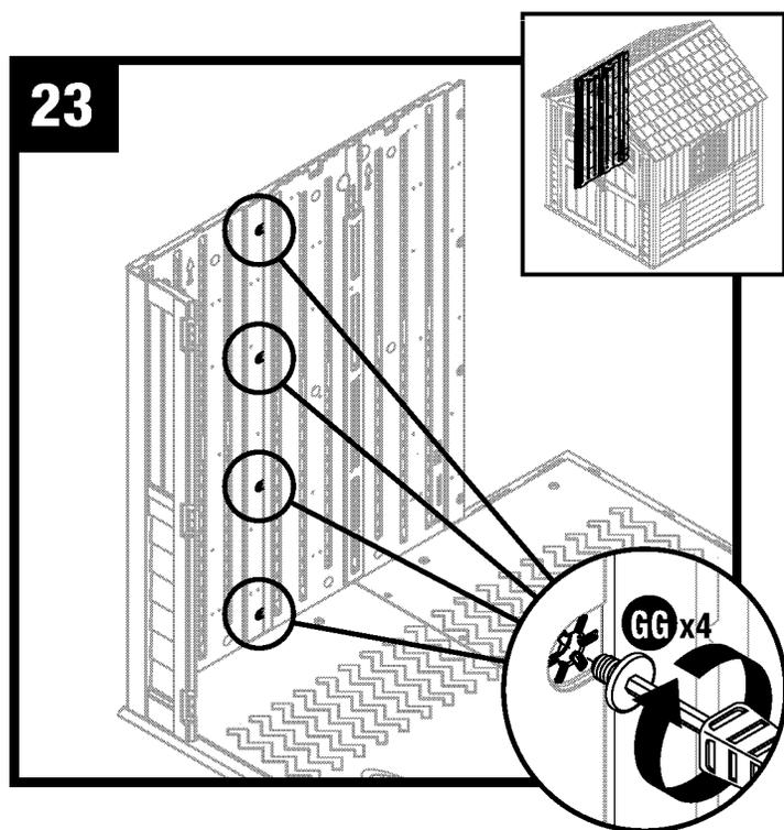
Fixez l'angle à l'aide de quatre boulons Easy (GG), en partant du plancher au toit. **N'UTILISEZ PAS** de clé dynamométrique. Utilisez l'outil Easy bolt easy driver (XX) et serrez à la main. La tête du boulon Easy s'encastre une fois bien en place. **NE SERREZ PAS** les boulons Easy trop fort.
