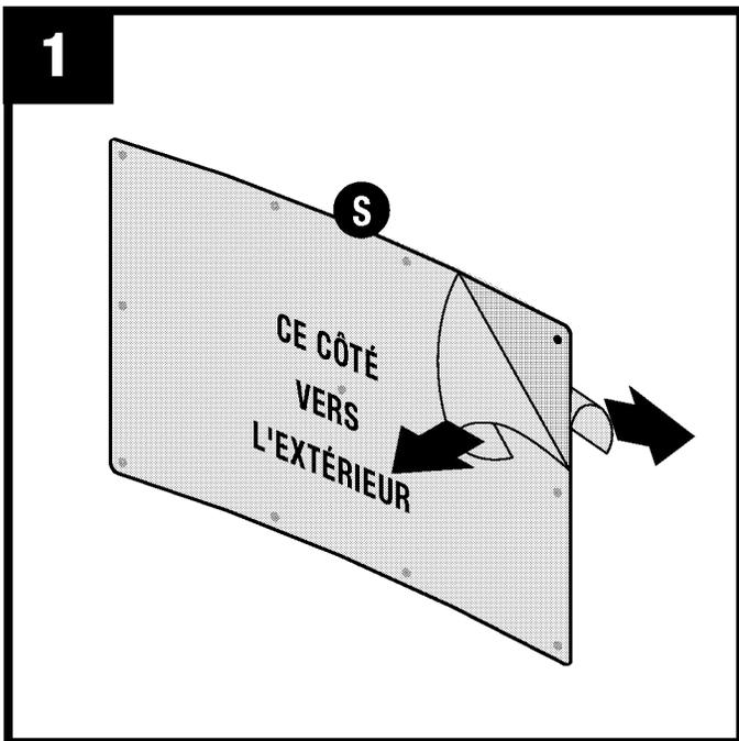
Retirez le film des deux faces de la fenêtre (S). Retirez également le film protecteur des bords de portes.
