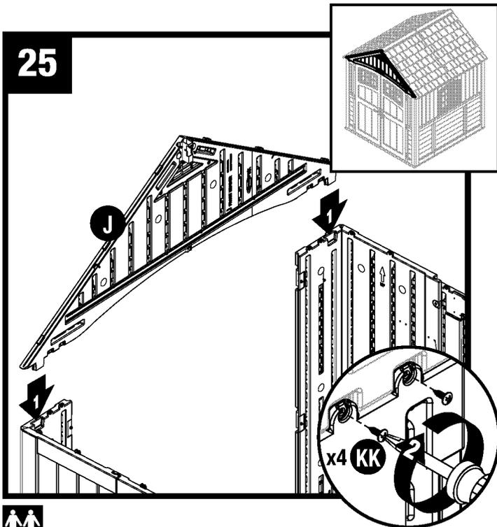
Placez le chevêtre avant (J) sur l'ouverture de la porte et insérez deux chevrons de soutien saillants dans les pochettes moulées des coins avant. Fixez le chevêtre avant à l'aide de deux vis (KK) dans chaque coin.
