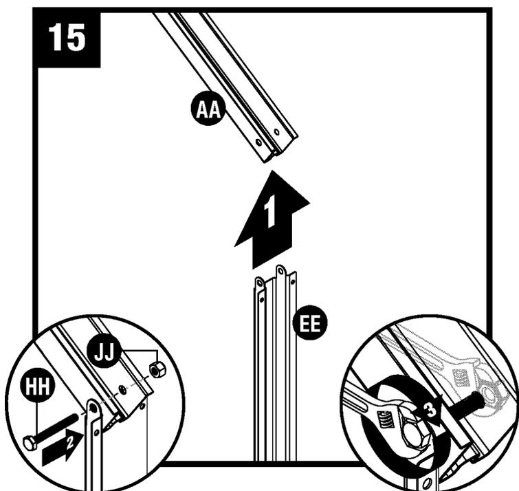
Placez une attache de ferme de la fenêtre (EE) à l'extrémité du chevron de ferme de droite (AA). Fixez l'attache de ferme à l'aide d'une vis à tête hexagonale de 5,08 cm (2 po) (HH) et d'un écrou (JJ).
