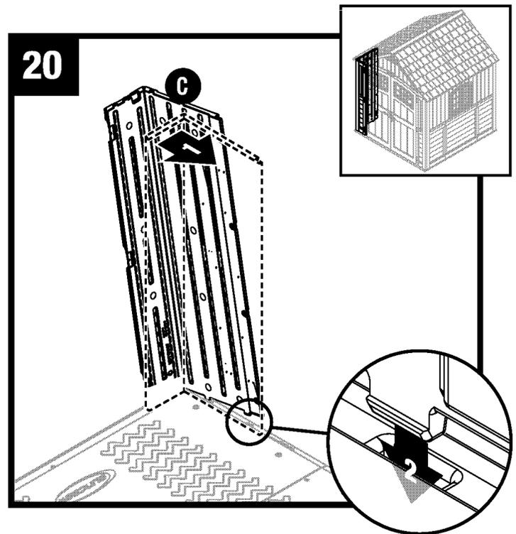
Redressez verticalement la partie arrière du côté avant gauche (C) et alignez les languettes inférieures du côté droit avec les fentes du plancher.
