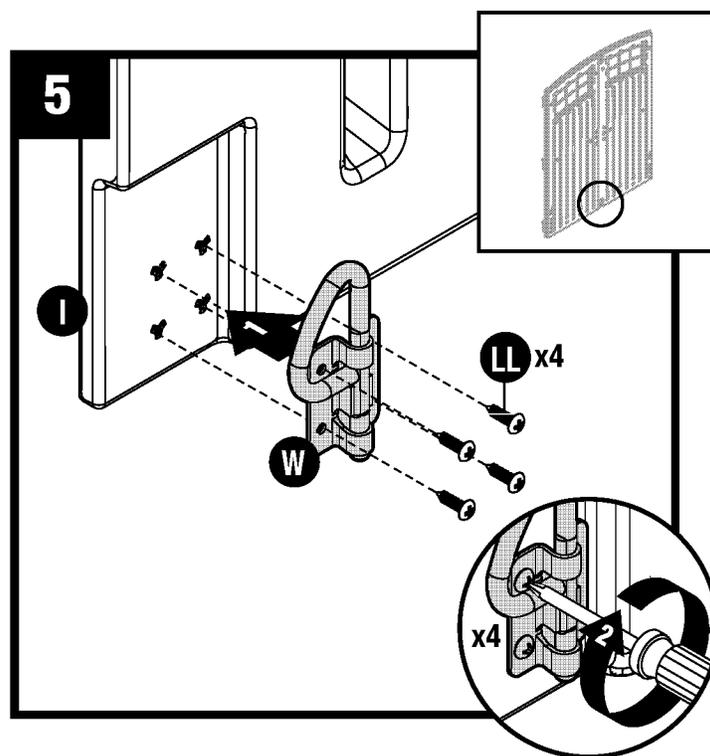
Sur le côté intérieur et inférieur de la porte gauche (I), fixez le verrou coulissant avec anneau en D (W) aux trous prévus à cet effet à l'aide de quatre vis (LL).
