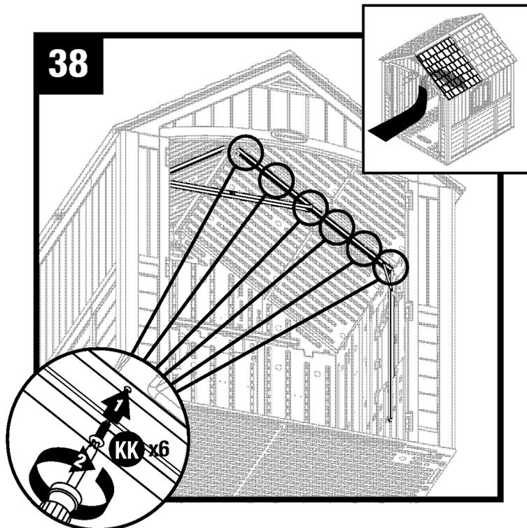
Depuis l'extérieur, tirez sur chaque angle inférieur du toit. À l'intérieur de la remise, fixez les languettes du panneau de fenêtre (F) et de l'angle avant droit (G) au panneau du toit avec quatre vis (KK).
