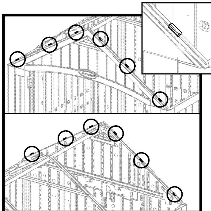
Avant de poursuivre, repérez et identifiez six languettes de chevêtre avant et six languettes de chevêtre arrière.
