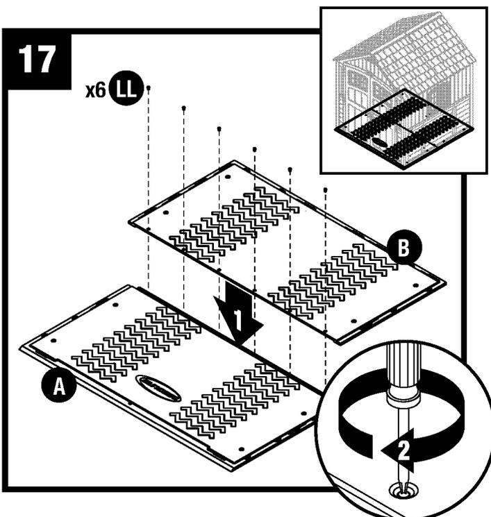
Rassemblez les panneaux des parties avant (A) et arrière (B) du plancher et fixez à l'aide de six vis (LL).
