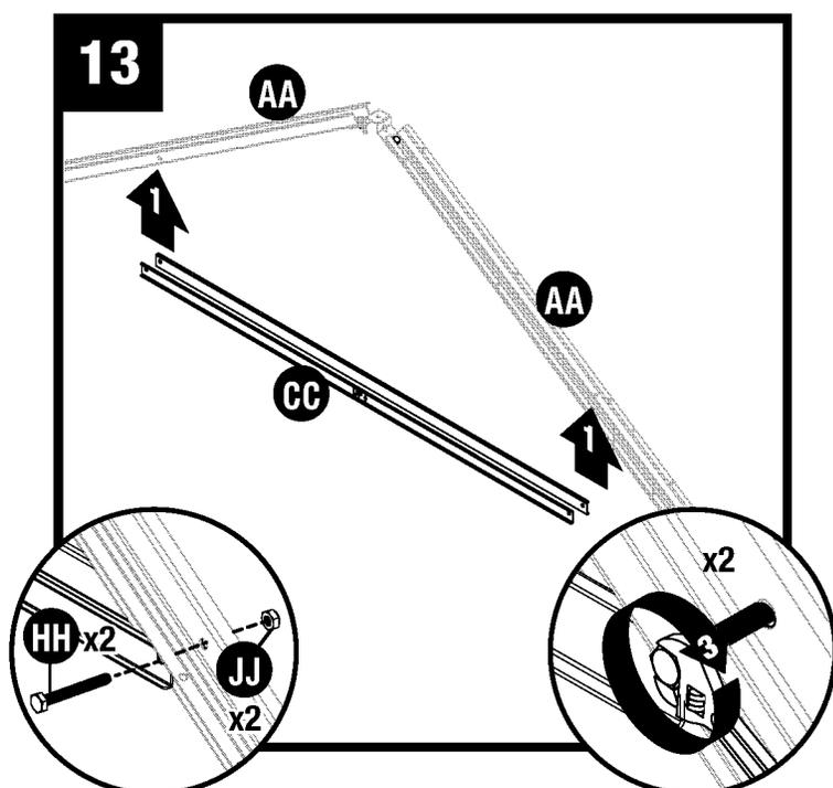
Fixez les traverses de ferme (CC) aux deux supports de ferme (AA) à l'aide de deux vis à tête hexagonale (HH) et de deux écrous (JJ). Relevez la ferme et vérifiez si les traverses sont de niveau.
