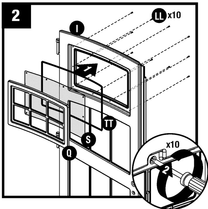
Redressez verticalement la porte de gauche (I). Dans cet ordre, disposez dans la rainure de la porte le joint de fenêtre (TT), la fenêtre de porte (S) et le seuil de fenêtre de porte (Q). À l'arrière de la porte, fixez les joints à l'aide de dix vis (LL). Commencez avec les quatre vis de coin et poursuivez avec les vis restantes. **NE SERREZ PAS** les vis trop fort.
