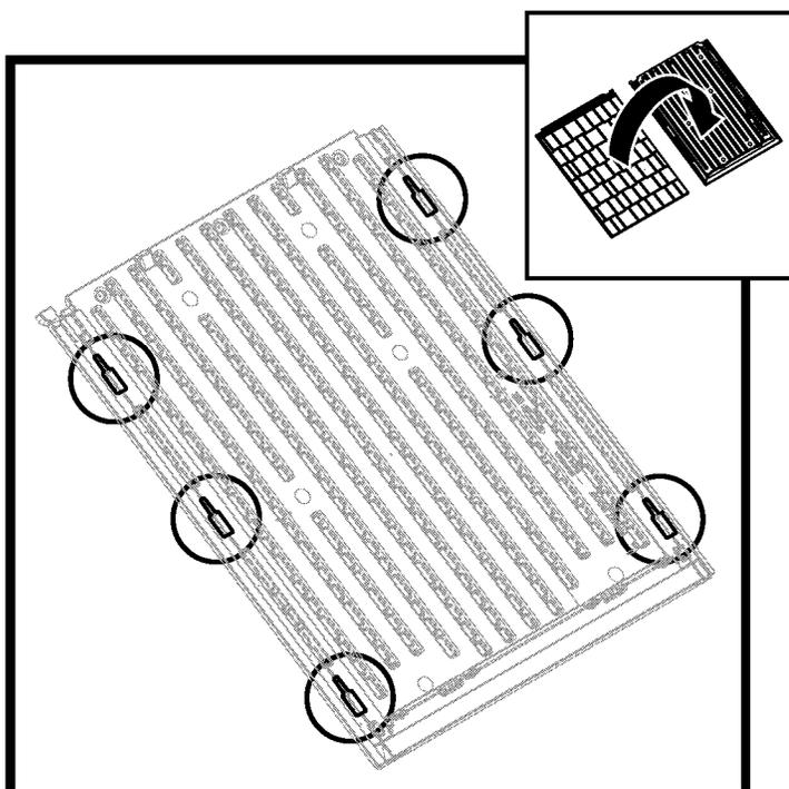
Avant de continuer, localiser et identifier les canaux sur le côté intérieur du toit droit (L) et le toit gauche (M). Localisez trois onglets face inférieure contenues dans chaque canal.
