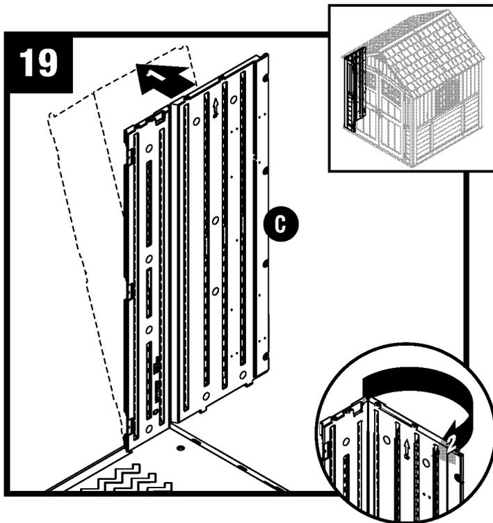
Inclinez légèrement le côté avant gauche (C) vers l'extérieur et pliez la charnière de l'angle.
