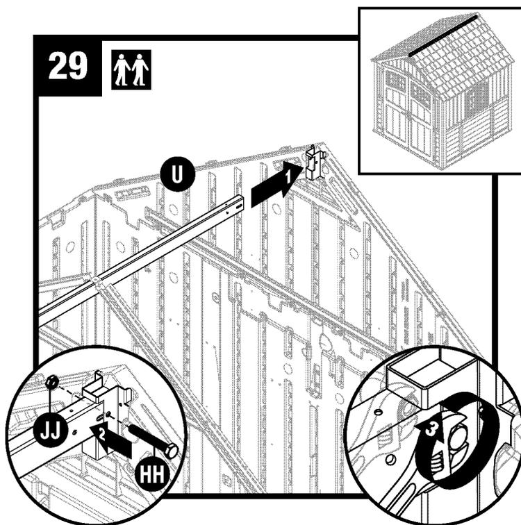
Soulevez la poutre faîtière (U) et insérez-la dans le support de la poutre faîtière arrière. Fixez à l'aide d'une vis à tête hexagonale de 5,08 cm (2 po) (HH) et d'un écrou (JJ).
