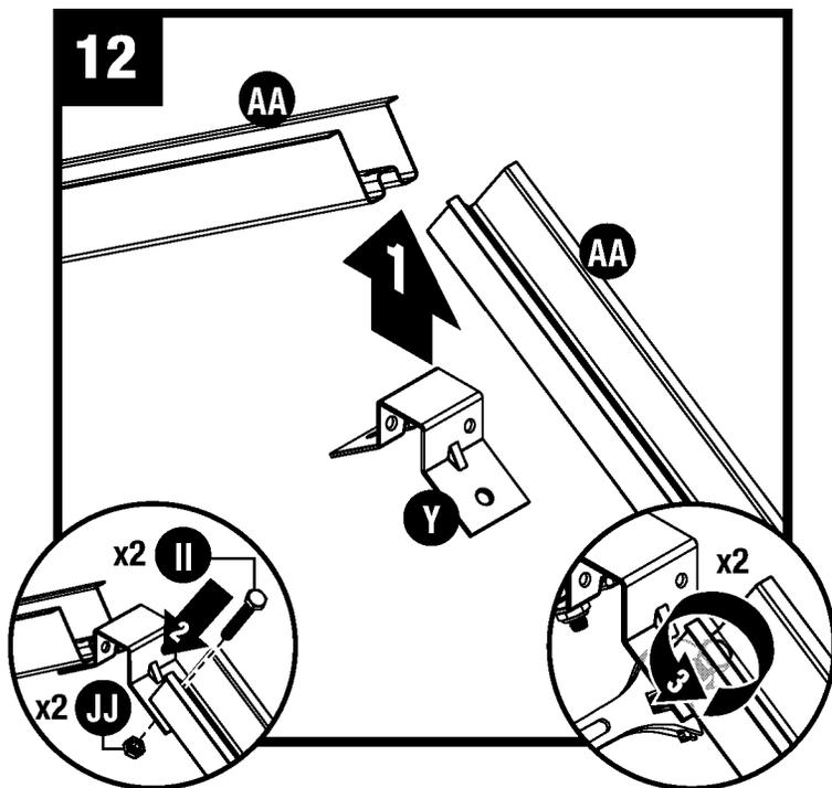
Fixez les chevrons de ferme (Y) à l'une des extrémités du support de ferme (AA) à l'aide d'une vis à tête hexagonale de 2,54 cm (1 po) (II) et d'un écrou (JJ).
