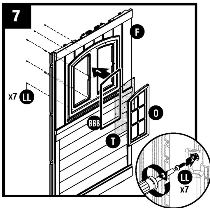
Redressez verticalement le panneau de la fenêtre latérale de droite (F). Dans cet ordre, disposez dans la rainure de la fenêtre le joint de fenêtre (BBB), la fenêtre latérale (T) et le seuil de fenêtre latérale de gauche (O). À l'arrière du panneau latéral, fixez les joints à l'aide de sept vis (LL). Commencez avec les quatre vis de coin et poursuivez avec les vis restantes.
