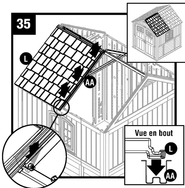
Enfoncez la bordure de la partie droite du toit (L) dans la rainure située dans le chevron de ferme (AA).
