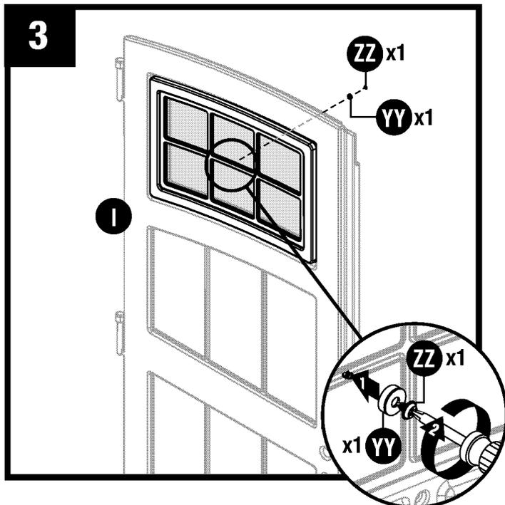
Fixez au centre de la fenêtre à l'aide d'une vis à tête à embase (ZZ) et d'une rondelle d'étanchéité (YY). **NE SERREZ PAS** les vis trop fort.
