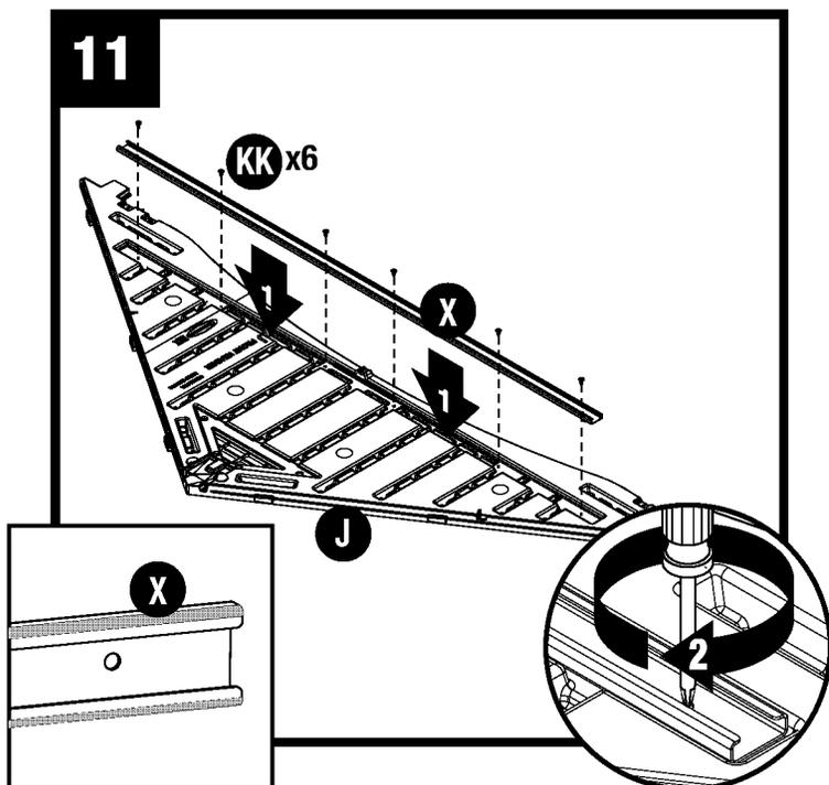
Posez le chevêtre (J) sur le sol, la face écrite orientée vers le haut. Insérez une poutre de chevêtre (X) dans la poche intérieure du chevêtre avant (J). Fixez à l'aide de six vis (KK). **NE SERREZ PAS** les vis trop fort.
