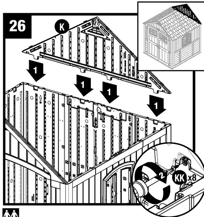
Placez le chevêtre arrière (K) sur les parois arrière et insérez quatre chevrons de soutien saillants dans les pochettes moulées des parois arrière. Fixez le chevêtre arrière à l'aide de huit vis (KK).
