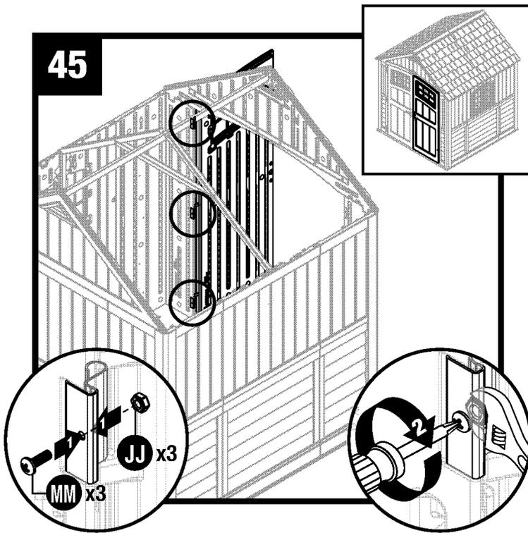
Fixez chaque plaque de charnière métallique à l'aide d'une vis (MM) et d'un écrou (JJ).
