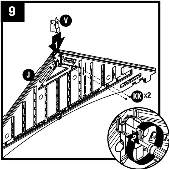
Glissez le support de la poutre faîtière (V) sous les languettes du sommet intérieur du chevêtre avant (J), puis fixez-le avec deux vis (KK). **NE SERREZ PAS** les vis trop fort.
