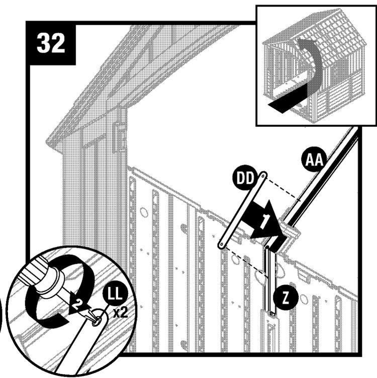
Fixez l'armature de ferme (DD) à l'attache de ferme de gauche (Z) et au chevron de ferme (AA). Fixez à l'aide de deux vis (LL). Faites de même avec le côté droit de la ferme.
