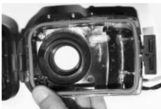
Étape 3 : Fermez soigneusement le boîtier pour finir d'insérer fermement l'O-ring et ouvrez le boîtier à nouveau pour vérifier que l'O-ring est parfaitement inséré dans son logement. Ne PAS graisser l'O-ring.
