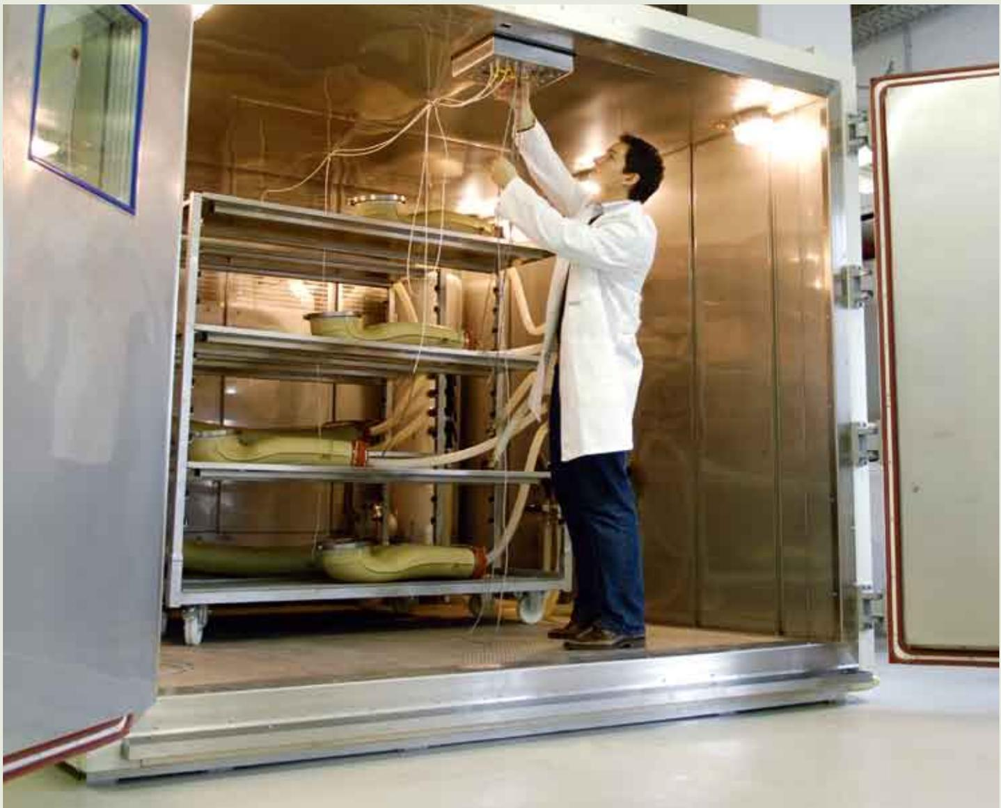
l'air contient une part trop importante d'eau, l'humidité peut être recueillie dans les pièces testées ou geler les composants.
