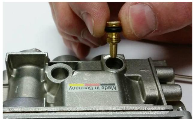
**Figure 22 – Enlèvement de la Vis de Basse Pression GN**
