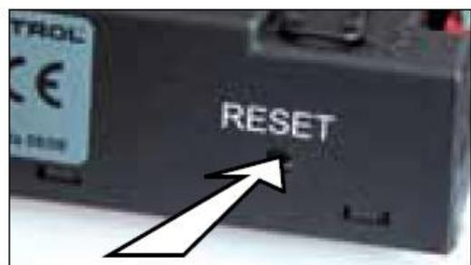
Figure 34 – Bouton de Réinitialisation du Récepteur
