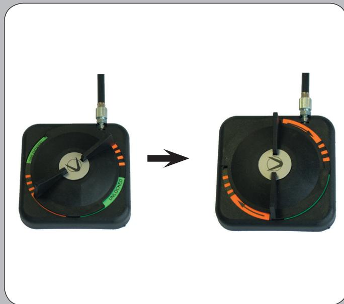
Pour rebloquer la ou les portes, tourner la poignée de déblocage dans le sens inverse des aiguilles d'une montre de manière à cacher le mot UNLOCKED/débloqué (les flèches réapparaissent). Au retour de l'alimentation de secteur, l'automatisme effectuera une première manœuvre d'ouverture à vitesse réduite, ensuite il recommencera à fonctionner normalement.
