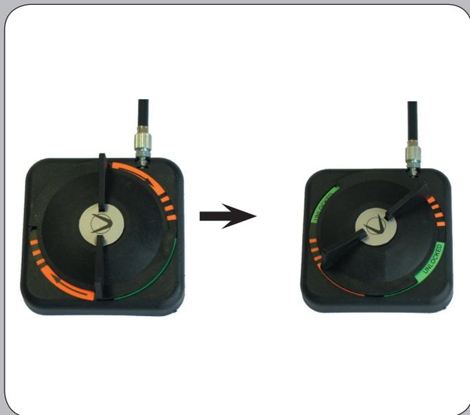
En cas de panne de courant, le déblocage est automatique et la porte reste ouverte jusqu'au retour de l'alimentation de secteur. Si ce n'est pas le cas, tourner la poignée de déblocage dans le sens indiqué par les flèches (sens des aiguilles d'une montre) jusqu'à ce que les flèches disparaissent (on voit apparaître le mot UNLOCKED/débloqué) et manœuvrer ensuite la ou les portes manuellement.
