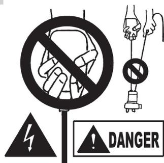
Ne jamais tirer la pompe par le câble d'alimentation ou le flotteur. Cela pourrait endommager la pompe irrémédiablement ou créer un choc électrique.
