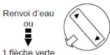
Réglez manuellement la roue de programmation en position « **Remplissage d'eau du bac à sel** », ou « **flèche verte** ».
