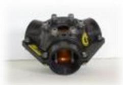
Le moyeu de l'hélice est fabriqué selon le procédé breveté **Carbone Forgé®**. Fabriqué à partir de nappes de fibres de carbone unidirectionnelles préimprégnées de résine époxy, celui-ci permet un gain de poids tout en ayant des caractéristiques de résistance mécanique exceptionnelles.
