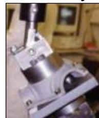
Pour ces deux cas, les résultats en termes de rigidité et charges apparentes de rupture sont exploités. La capacité des cellules de charge étant limitée, l'essai ne pourra atteindre la rupture de la pièce dans la plupart des cas. En outre, la rupture des vis de fixation des pièces sur l'outillage durant les essais se sont plusieurs fois produites.
