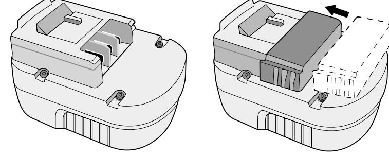
⚠ ADVERTENCIA: Asegúrese de que las terminales de la batería no entren en contacto con metales. Por ejemplo, no coloque la batería en un delantal, bolsillos, cajas de herramientas, estuches del producto, cajones etc. sin antes colocarle la tapa. Sin la tapa, la batería puede entrar en corto circuito causando incendio o quemadura a la batería.
