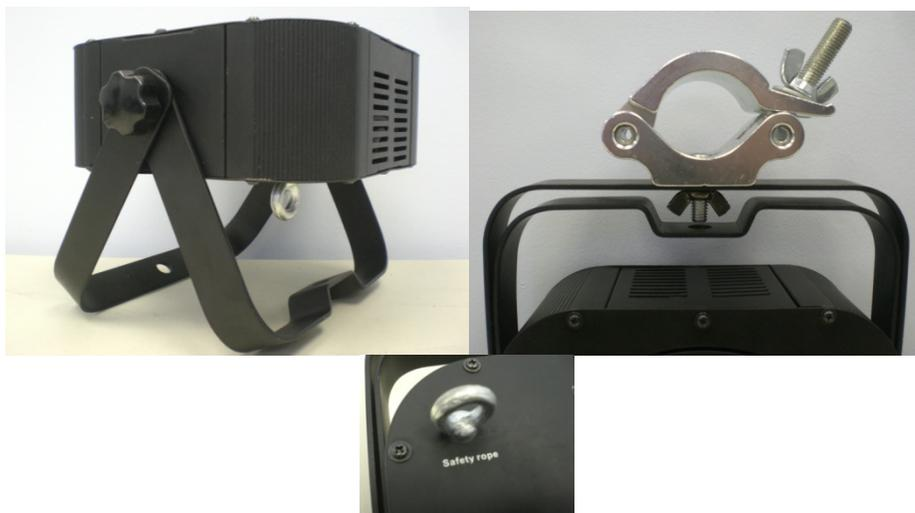
Peu importe l'option de réglage que vous choisissez pour votre lumière MICROH SLIM P7/P12, toujours s'assurer de sécuriser l'appareil avec le câble de sécurité. Cette lumière offre un point de réglage intégré pour un câble de sécurité sur le support de la pendaison comme illustré ci-dessus. Veuillez utiliser uniquement le point désigné pour attacher le câble de sécurité et de ne jamais servir de la poignée de transport pour attacher le câble de sécurité.
