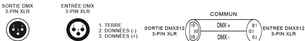
Pour les installations où le câble DMX doit couvrir une grande distance, ou s'il est installé dans un environnement électriquement bruyants, il est recommander d'utiliser un terminateur DMX. Ceci aide à la prévention de la corruption du signal digitale par les bruits électriques. Le terminateur DMX est simplement une prise XLR avec une résistance 120 Ω connecté entre les pins 2 et 3. Ceci est ainsi brancher dans la sortie XLR du dernier appareil dans la série. Veuillez voir le dessin ci-dessous.
