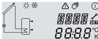
L'écran System-Monitoring se compose de 3 champs: l'**indicateur de canaux**, la **réglette de symboles** et l'**indicateur de schémas de systèmes** (schéma actif des systèmes).
