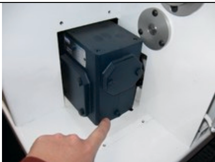
22. Une fois par année, enlevez la vis du drain et faire sortir l'huile. Quand c'est fait, remettez la vis.
