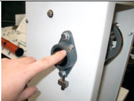
20. Utilisez un fusil à graisse pour lubrifier chaque roulement a bille
