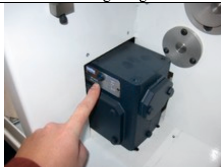
23. Enlevez la vis du haut et ajouter 500ml d'huile 80W90. Quand c'est fait, remettez la vis.
