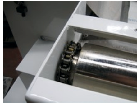
19.1 Ajoutez de la graisse alimentaire sur la chaîne. Il se peut que vous deviez la nettoyer avant.
