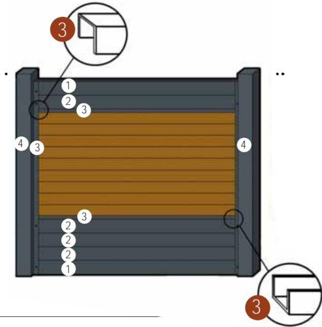
**1** Profil de départ et de finition aluminium 24 x 100 mm
