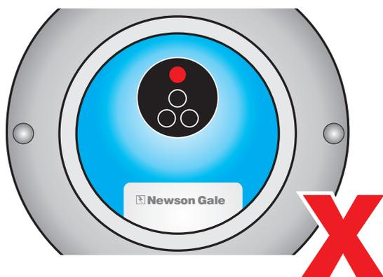
**C.** Si la connexion entre le camion-citerne et la terre est interrompue au cours de l'opération de transfert la DEL **rouge**, indiquant l'absence de raccordement à la terre, s'allume et les contacts d'interverrouillage s'ouvrent.
