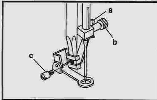
Retirez la barre du pied-de-biche et installez le pied de piqué libre/pied à reprisage sur la barre du pied-de-biche. Le levier (a) devrait se trouver derrière la vis à aiguille (b). Appuyez fermement sur le pied de piqué libre/pied à reprisage par derrière avec votre index et serrez la vis (c).
