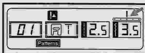
Lorsque les motifs 01-05 sont sélectionnés, les boutons de réglage de la largeur de point permettent de modifier la position de l'aiguille. Si vous appuyez sur le bouton (gauche) « - », l'aiguille se déplace vers la gauche et si vous appuyez sur le bouton « + » (droite), l'aiguille se déplace vers la droite. Les chiffres varient alors entre la position tout à gauche, « 0,0 » et la position tout à droite « 7,0 ». La position centrale de l'aiguille préréglée est indiquée par « 3,5 ».
