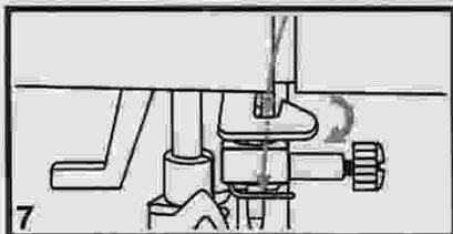
7. Faites passer le fil derrière le guide-fil horizontal et plat.
