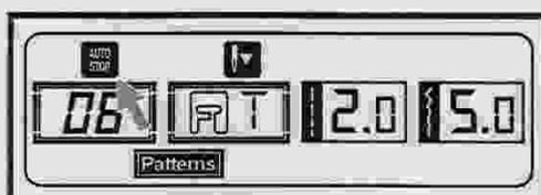
Lorsque vous sélectionnez les motifs 06-16, 32-60 appuyez sur le bouton d'auto-verrouillage, la machine pique 3 points de fermeture à la fin du motif actuel et s'arrête automatiquement. L'écran LCD affiche l'icône «
