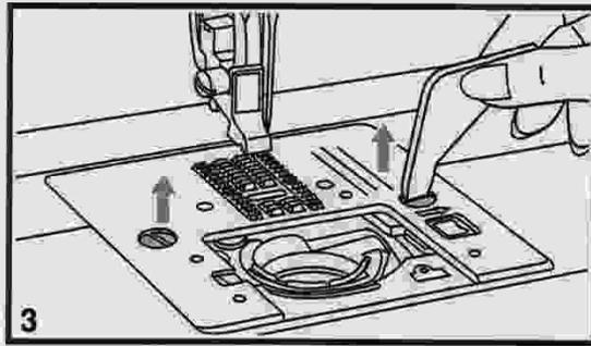
3. Retirez l'aiguille, le pied-de-biche et la barre du pied-de-biche. Retirez la vis tenant la plaque à aiguille puis retirez la plaque à aiguille.
