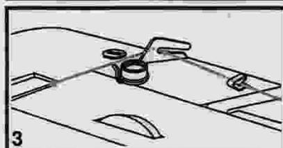
Commencez par relever l'aiguille à son point le plus haut en tournant le volant vers vous. Relevez le releveur de pied-de-biche pour ouvrir les disques de tension.
