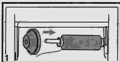
1. Placez la bobine et son capuchon sur la broche porte-bobine. Pour les petites bobines de fil, placez le petit côté du capuchon de bobine sur la bobine ou utilisez le petit capuchon de bobine.
