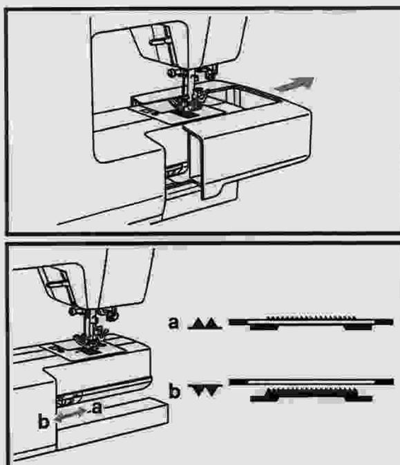
Retirez la boîte à accessoires de la machine, vous pouvez alors voir le levier de réglage des griffes d'entraînement en bas, à l'arrière de la machine à coudre.
