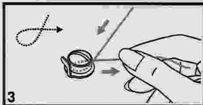
3. Enroulez le fil dans le sens des aiguilles d'une montre autour des disques de tension du fil de la bobine.
