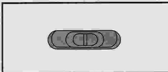
Le levier de réglage de la vitesse peut contrôler la vitesse de couture. Pour augmenter la vitesse, faites glisser le levier vers la droite. Pour abaisser la vitesse, faites glisser le levier vers la gauche.
