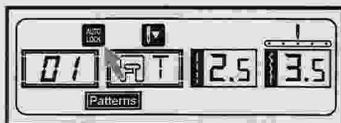
Lorsque les motifs 01-05 sont sélectionnés, la machine pique immédiatement 3 points de fermeture lorsque vous appuyez sur le bouton d'auto-verrouillage, puis elle s'arrête automatiquement. L'écran LCD affiche l'icône «
