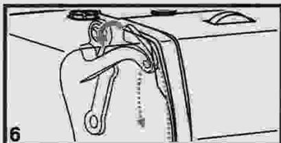
6. Faites passer le fil de droite à gauche dans l'œil à fente du releveur de fil puis faites-le descendre à nouveau.
