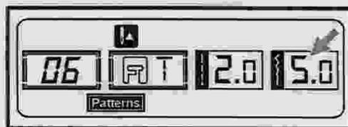
Lorsque vous sélectionnez un point, la machine règle automatiquement la largeur de point recommandée qui sera indiquée par des chiffres sur l'écran LCD. La largeur de point peut être modifiée en appuyant sur les boutons de réglage de la largeur de point.
