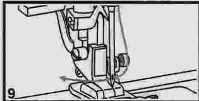
9. Enfilez l'extrémité du fil dans le chas de l'aiguille de l'avant vers l'arrière et tirez environ 10 cm de fil. Ou utilisez l'enfile-aiguille pour enfiler l'aiguille. (Voir page suivante).
