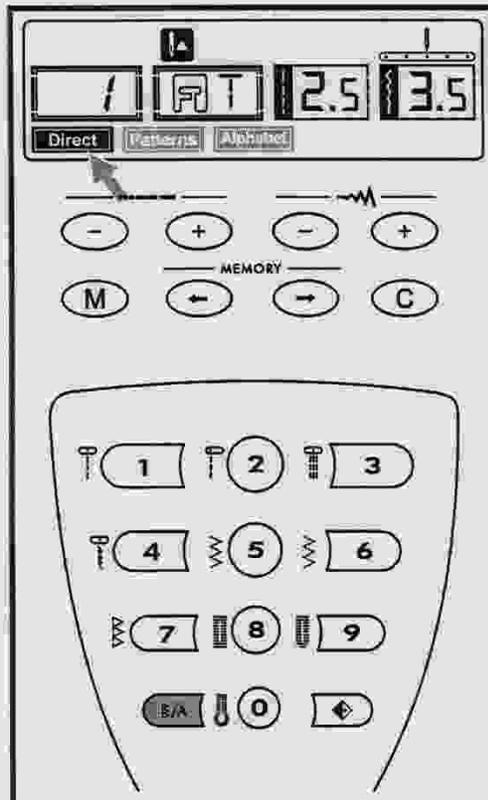
Lorsque vous allumez la machine, l'écran LCD s'allume en mode direct « **Direct** ».
