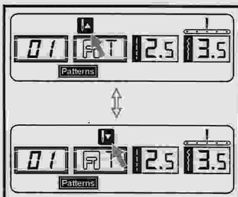
Avec le bouton relever/abaisser l'aiguille, vous décidez si l'aiguille doit s'arrêter en position haute ou dans le tissu lorsque vous vous arrêtez de coudre.
