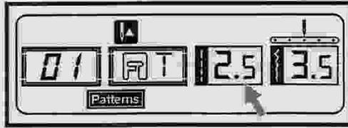
Lorsque vous sélectionnez un point, la machine règle automatiquement la largeur de point recommandée qui sera indiquée par des chiffres sur l'écran LCD. La longueur de point peut être réglée en appuyant sur les boutons de réglage de la longueur de point.
