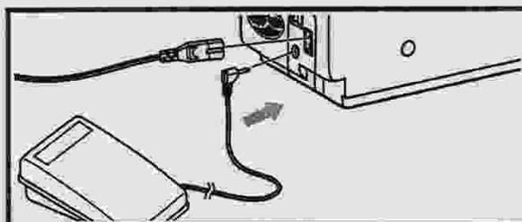
Quand la machine à coudre est éteinte, insérez la fiche de la pédale de commande dans la prise située sur la machine à coudre.
