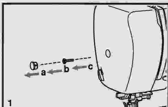
1. Débranchez la prise (a), dévissez la vis (b) du côté gauche de la machine à coudre et retirez la plaque frontale (c).
