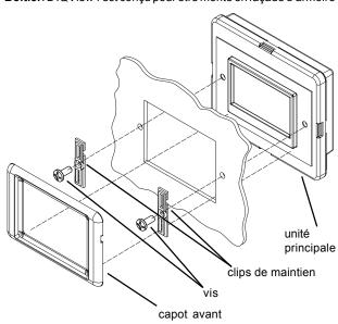
L'assemblage de l'écran d'affichage se compose de l'unité principale, 2 clips de maintien, 2 vis et une plaque de protection avant.
