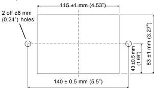
Le panneau doit être assemblé en découpant un carré pour l'écran, et être percé avec deux trous de 6 millimètres (0.24") pour les vis. L'unité principale est apposée sur le carré en ajustant le cadre de l'écran avec le trou, les vis sont ensuite serrées par les agrafes de maintien dans l'unité principale pour la tenir en place. La plaque de protection se clips ensuite sur les agrafes de maintien.
