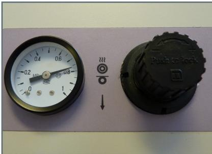
25. Réglez la pression de laminage comme il convient. La pression recommandée est entre 6 et 8 bars.
