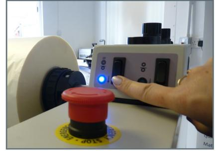
18. Appuyez sur l'interrupteur du rouleau de laminage. Le rouleau s'abaisse et une lumière s'allume.
