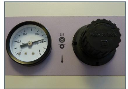
27. Réglez la pression de laminage comme il convient. La pression recommandée est entre 6 et 8 bars.
