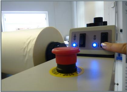
19. Appuyez sur l'interrupteur du rouleau de pression. Le rouleau s'abaisse et une lumière s'allume.
