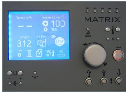
2. Utilisez les boutons de baisse et hausse de température pour sélectionner la bonne température pour les rouleaux de laminage supérieur et inférieur.
