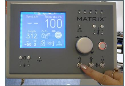
24. Appuyez sur le bouton avancer et sélectionnez une vitesse faible (0,50 à 2,0m/m) pour le chargement.
