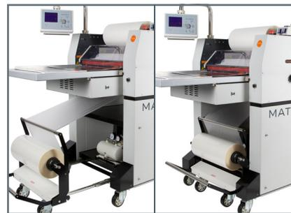
8. Enfilez le film sur la barre inférieure tel que cela est indiqué. Repoussez l'unité du film inférieure vers la machine principale et bloquez.
