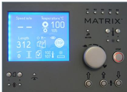
2. Utilisez les boutons de baisse et hausse de température pour sélectionner la bonne température pour les rouleaux de laminage supérieur et inférieur.
