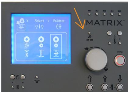
1. Appuyez sur le bouton de réglage une fois. Utilisez les boutons de température pour sélectionner le mode « encapsulage ».
