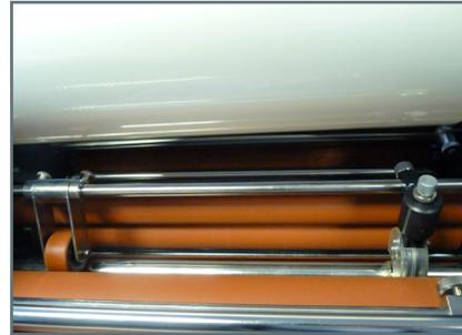
23. Placez la roue de guidage sur le côté opposé de la feuille par rapport à la roue de perforation.
