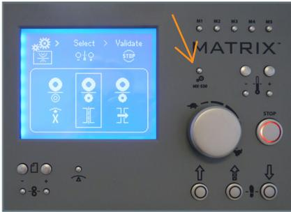
1. Appuyez sur le bouton de réglage une fois. Utilisez les boutons de température pour sélectionner le mode « double face ».
