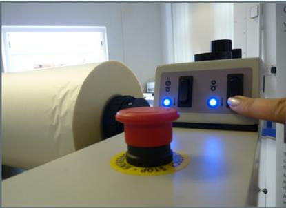
19. Appuyez sur l'interrupteur du rouleau de l'unité de contrôle pneumatique. Le rouleau s'abaisse et une lumière s'allume.
