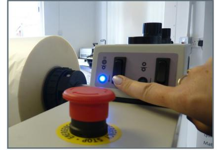
18. Appuyez sur le rouleau de laminage pour allumer l'unité de contrôle pneumatique. Le rouleau s'abaisse et une lumière s'allume.
