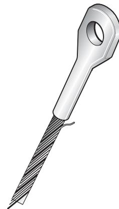
Le gréement dormant qui reste en contact avec le mât pendant l'hivernage peut provoquer une corrosion du mât par réaction galvanique entre l'acier et l'aluminium. Ce risque n'est pas négligeable en atmosphère humide et salée.
