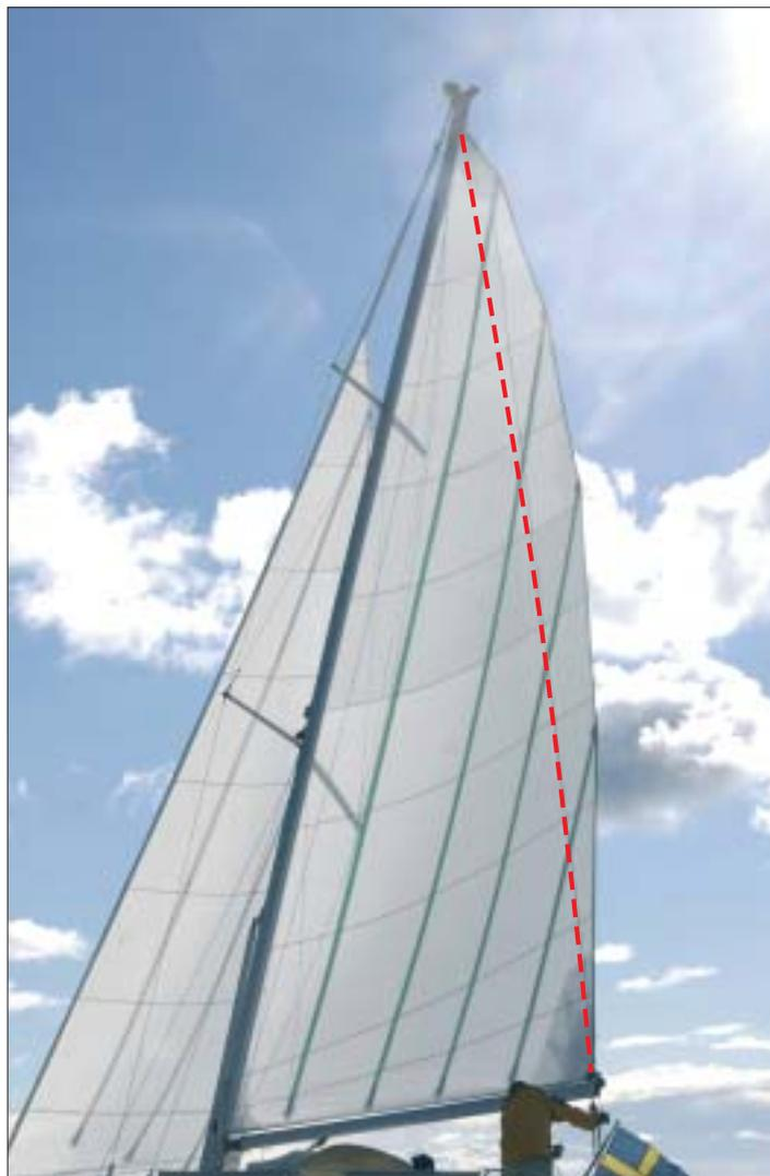
Ceux qui pensaient qu'une voile sur enrouleur était moins performante à cause d'un rond de chute insuffisant avaient tort. Les nouveaux mâts enrouleur Seldén sont conçus pour accepter des lattes verticales et un véritable rond de chute positif.
