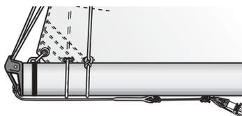
*Afin de faciliter l'utilisation d'une retenue de bôme, une estrope peut être installée de façon permanente entre l'embout de la bôme et le coulisseau de hale-bas. Fixer l'estrope sur l'embout de bôme, faire un oeil épissé à l'autre extrémité sur lequel sera fixé un sandow. Au repos, le mou de l'estrope sera repris en tendant le sandow.*
