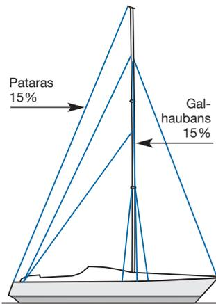
Des bastaques sont nécessaires pour obtenir une stabilité longitudinale suffisante et obtenir la tension voulue sur l'étai. Les pataras doivent être fixés aussi près que possible de l'axe longitudinal de la coque, de façon à ne pas affecter le réglage latéral. Ce type de gréement se rencontre aussi avec bas haubans simples, dans ce cas des basses bastaques sont recommandées pour contrôler un cintrage excessif du mât.
