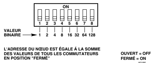
Figure 17—Commutateurs d'Adresse pour le X3302
