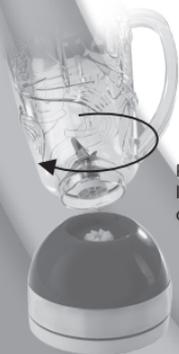
Pour enlever le mixeur, le tourner dans le sens des aiguilles d'une montre.
