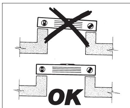
Un corretto livellamento delle fondazioni o della struttura di appoggio è molto importante per prevenire dannose vibrazioni.
