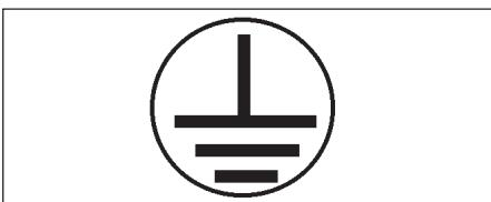
Controllare il collegamento di messa a terra.
