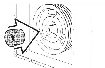
inserire la bussola nella puleggia, avendo cura di far coincidere i semi fori filettati della puleggia con i semi fori non filettati della bussola
