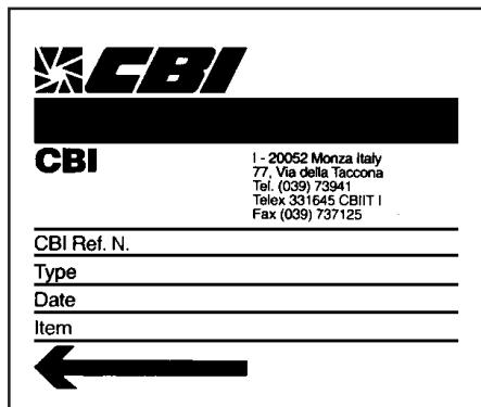
Per ordinare i ricambi contattare direttamente CBI indicando oltre al particolare richiesto (albero, girante, cuscinetti, ecc.), tutti i dati riportati sulla targhetta di identificazione del ventilatore.
