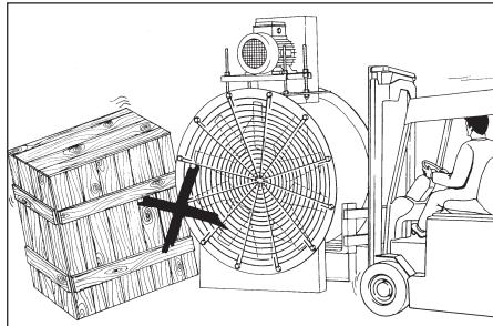
La movimentazione deve avvenire con estrema cura, evitando urti che potrebbero danneggiare la verniciatura esterna del ventilatore e potrebbero anche compromettere il corretto funzionamento.
