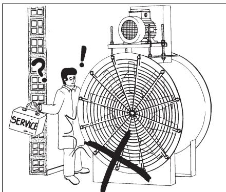
Posizionare il ventilatore in modo da garantire sempre uno spazio minimo per gli interventi di manutenzione e di riparazione.
