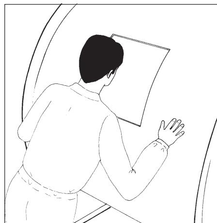
si consiglia pure di ispezionare regolarmente (mediamente ogni 3 mesi) la girante attraverso la portella d'ispezione, specialmente se si avvertono vibrazioni.
