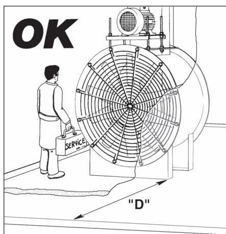
Prevedere, alla necessaria distanza di sicurezza, una barriera che impedisca l'avvicinamento involontario alle bocche del ventilatore non canalizzate.
