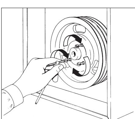
avvitare le tre viti rimosse per lo smontaggio in modo uniforme ed alternativamente sino al completo bloccaggio della puleggia
