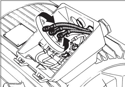
Se il senso di rotazione è diverso, isolare il ventilatore dall'alimentazione elettrica e invertire le fasi nella morsettiera.
