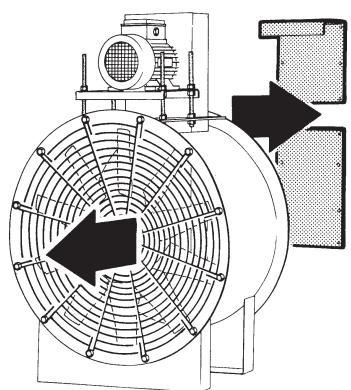
Le protezioni di sicurezza non devono essere rimosse se non per assoluta necessità di lavoro; nel qual caso dovranno essere immediatamente adottate idonee misure atte a mettere in evidenza il possibile pericolo.
