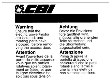
Vieta l'apertura della portella d'ispezione con ventilatore in funzione.
