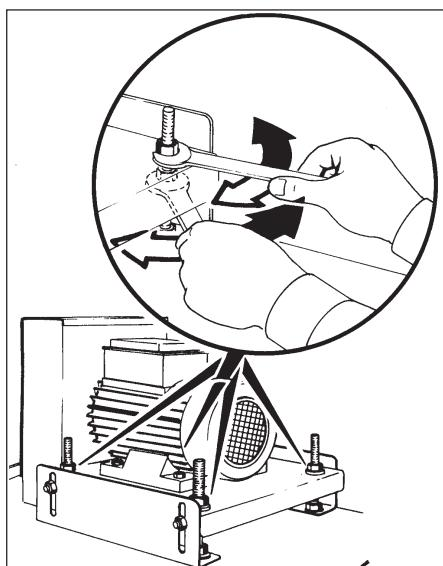
successivamente allentare le viti di bloccaggio della piastra di supporto del motore
