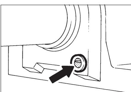
verificare che i cuscinetti del ventilatore e del motore siano lubrificati.
