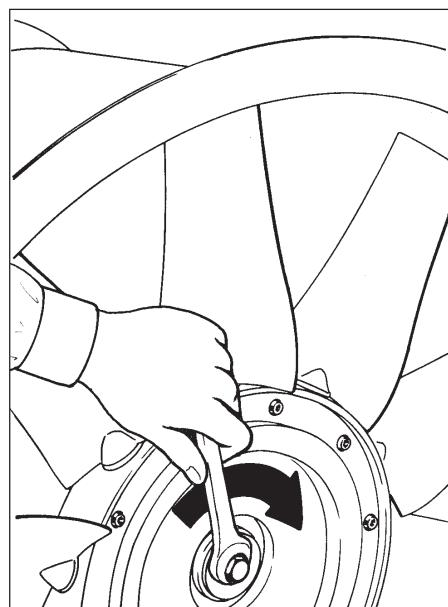
il serraggio di tutta la bulloneria, la tensione delle cinghie, l'allineamento della trasmissione, ed il buono stato degli antivibranti.
