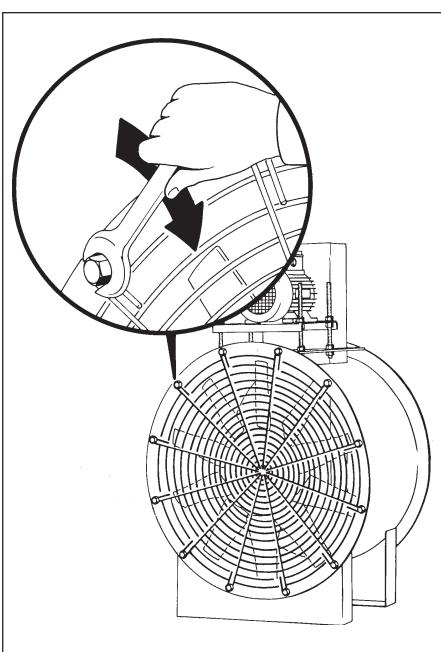
Controllare che tutti i carter di protezione siano montati e verificare il serraggio della bulloniera.
