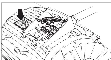
Prima di collegare il cavo di alimentazione elettrica alla morsettiera del ventilatore verificare che la tensione di linea sia idonea a quella riportata sulla targhetta posta sul motore.
