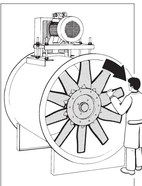
Provare manualmente che la girante non si sfreghi sulle pareti.
