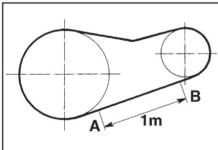
Prima di tendere le cinghie contrassegnare sul ramo teso un tratto A-B pari ad 1 metro ed effettuare il 1° tensionamento fino ad allungare il tratto A-B di 5 mm.
