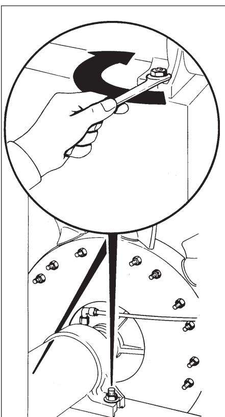
Dopo un'ora circa di funzionamento controllare il serraggio della bulloneria, in particolare quelli del monoblocco,
