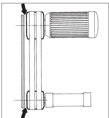
Controllare l'allineamento delle pulegge.
