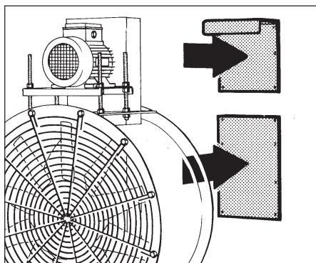
Per poter smontare le cinghie bisogna innanzitutto rimuovere il carter di protezione della trasmissione,
