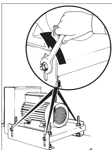
ed agire sulle viti di regolazione per ridurre l'interasse tra la puleggia del motore e quella del ventilatore.
