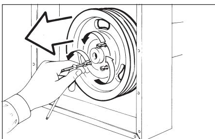
sbloccare le tre viti di serraggio ed inserirne una nel foro libero, avvitare a fondo sino a sbloccaggio avvenuto
