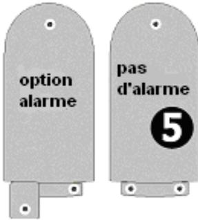
Maintenir le récepteur contre le mur et repérer les trous de perçage. Utiliser la visserie fournie (ou une visserie plus adaptée aux matériaux) et fixer le produit au mur.
