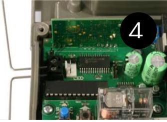
Prendre les deux antennes dans l'emballage et les visser au récepteur (cf. ci-contre pour repérer les antennes et le connecteur en haut à gauche de la carte électronique). S'assurer que les deux antennes ne se touchent pas, ne se croisent pas et qu'elles pointent dans des directions opposées (une vers le haut, une vers le bas, toutes les deux parallèles au côté du produit).
