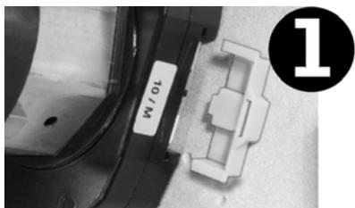
Retirer le capot de protection des fins de course mécanique du moteur.
