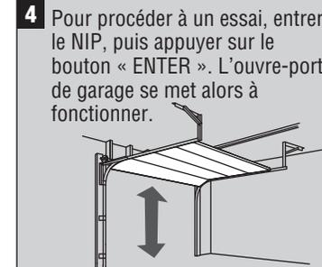
Pour procéder à un essai, entrer le NIP, puis appuyer sur le bouton « ENTER ». L'ouvre-porte de garage se met alors à fonctionner.
