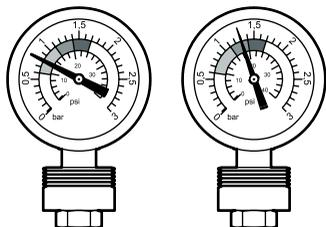
Quand l'augmentation de la pression par rapport à la valeur initiale est de 0,5 kg/cm<sup>2</sup>, le filtre se trouve près du point de saturation, ce qui réduit sa capacité de filtration.
