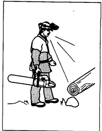
5. Etre extrêmement prudent en coupant des branches ou des rondins sous tension. Un rondin ou une branche sous tension peut se redresser brutalement dans sa position naturelle après ou avant qu'il ne soit coupé. Si vous êtes du mauvais côté ou commencez à couper au mauvais endroit, il peut vous heurter ou heurter la tronçonneuse. Ceci peut vous faire perdre contrôle et causer un accident grave.
