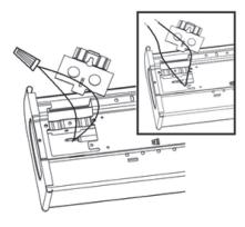
3 . Retirer le connecteur de fils à torsade.
