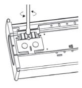
2 . Retirer le connecteur de fils à torsade.
