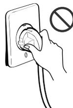
**Utilisé une prise de courant dédiée pour cet appareil.**
