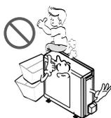
**N'insérez pas les mains ou d'autres objets à travers l'entrée ou la sortie d'air lorsque le climatiseur est branché.**
