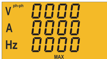
Figure 10 : Écran de données instantanées affichant les valeurs maximales
