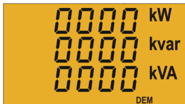
Figure 12 : Écran de données instantanées affichant la valeur de demande maximale
