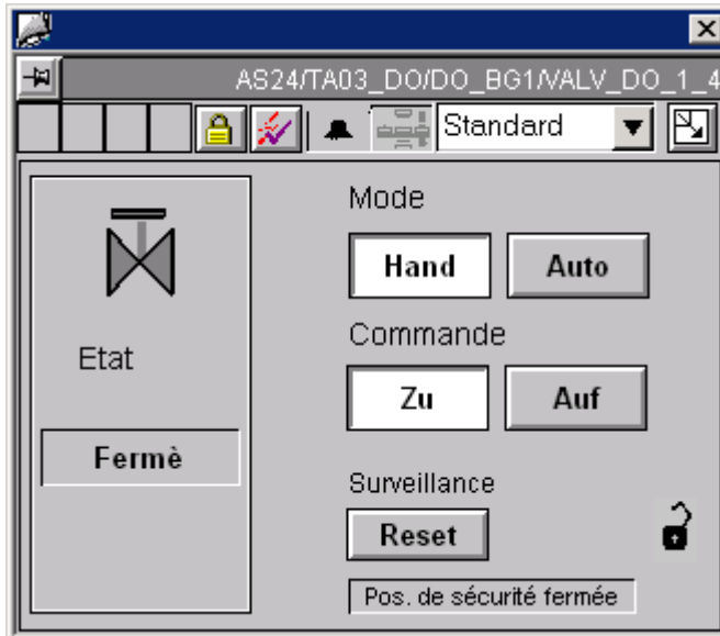
Blocs d'affichage sous forme de vue groupée dans la fenêtre de process
