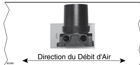
Figure 7—Orientation de la Plaque de Fixation du PIRDUCT par rapport à la Direction du Débit d'Air dans la Gaine
