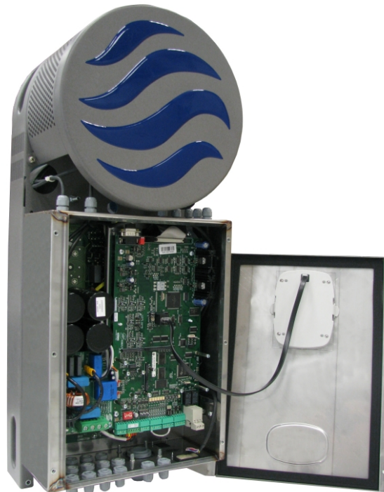
Figure 13 : Intérieur de l'onduleur ETESIAN MINI
