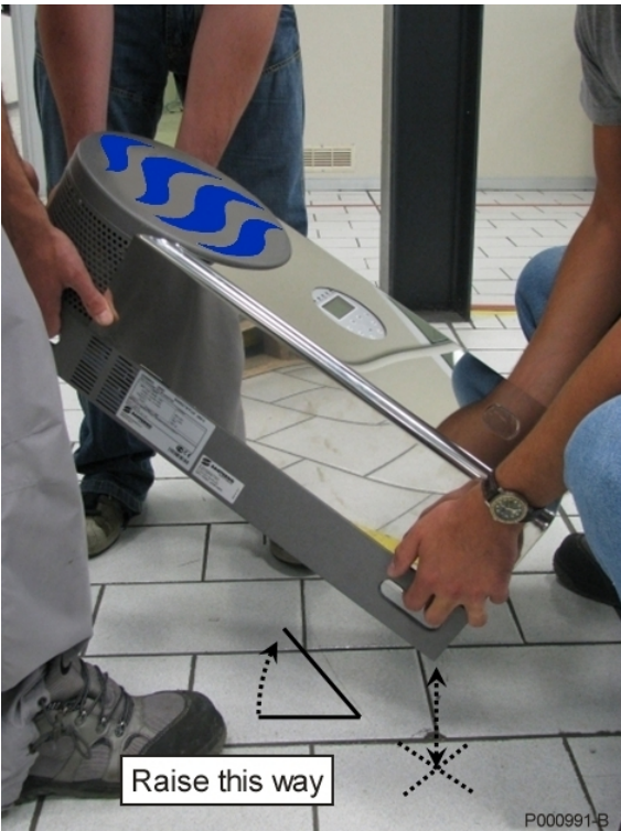
Figure 6 : Exemple de manutention de l'onduleur ETESIAN MINI
