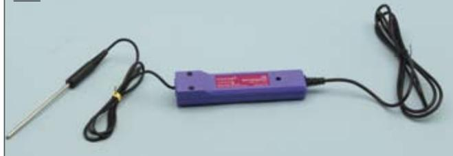
**9085** Capteur de température USB
