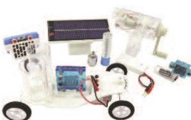
Réaliser des expériences avec les solutions énergétiques pour les transports de demain. Ensemble permettant de montrer différentes solutions de stockage d'énergie et d'alimentation électrique pour les véhicules.
