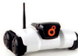
Le Spy-C Tank est un robot piloté par WiFi à l'aide d'une application tablette ou smartphone (iOs ou Android). Sa caméra retranscrit en direct les images filmées sur l'écran de votre smartphone ou tablette.
