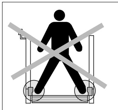
Fig. 1. Des capteurs disposés face-à-face ne doivent pas pouvoir être activés en même temps
