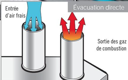
La technologie de l'évacuation directe tire l'air de l'extérieur pour effectuer la combustion et évacue les gaz de combustion par un deuxième évent. Les deux événements sont installés dans votre cheminée actuelle.
